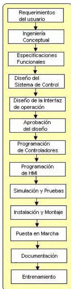
Figura 6.1 Pasos a seguir para el diseño de un sistema de automatización
