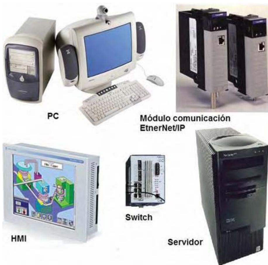
Figura 3.11. Dispositivos de la red EtherNet/IP.
