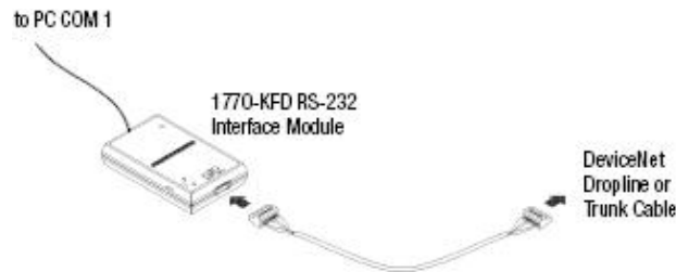
Figura 2.43 Conexión de PC a DeviceNet mediante 1770-KFD
