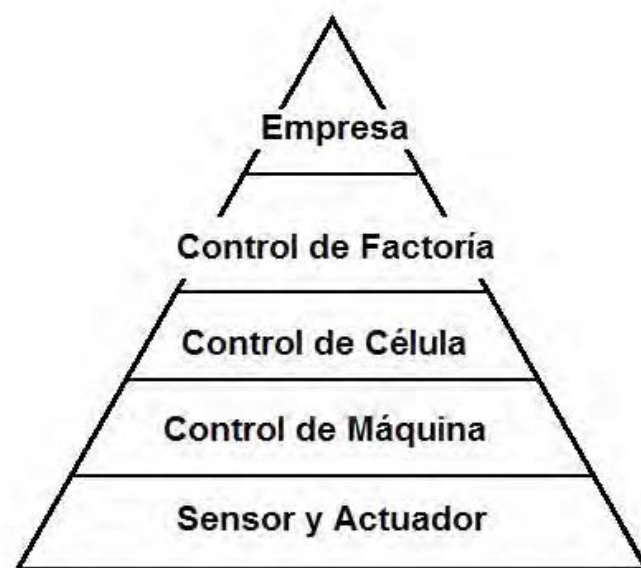
Figura 1.1 Modelo CIM según la NBS de los EE. UU.
