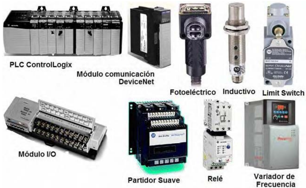
Figura 3.5. Dispositivos de la red DeviceNet.
