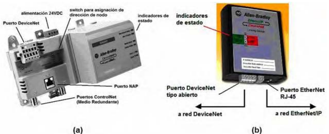
Figura 3.6. Bridge para la interconexión de las redes: (a) DeviceNet a ControlNet, y (b) DeviceNet a EtherNet/IP.
