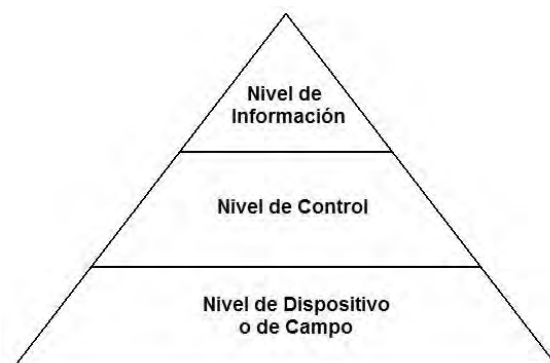
Figura 3.1. Pirámide que representa en forma jerárquica los niveles de comunicación de la plataforma de red NetLinx.
