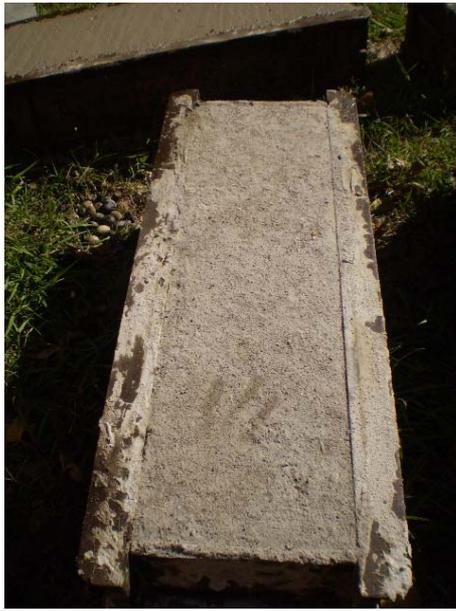
Probeta sin curado.
