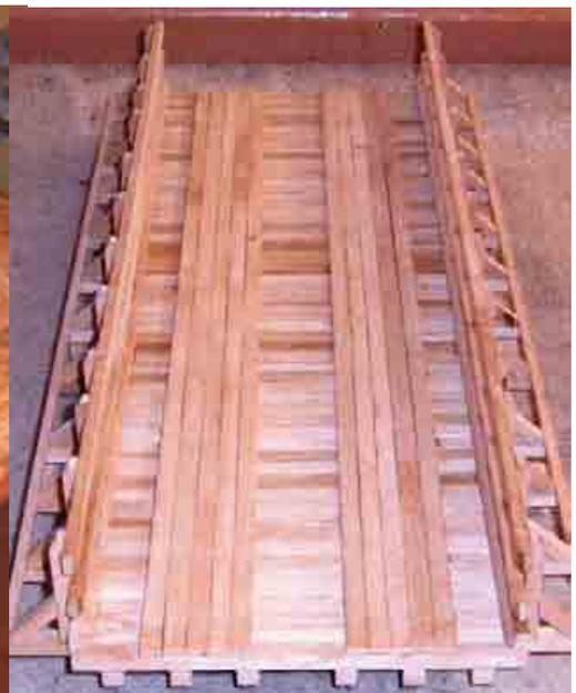
Foto 4: Vista inferior del puente. En la imagen se puede apreciar vigas de piso y la colocación de los elementos metálicos.
