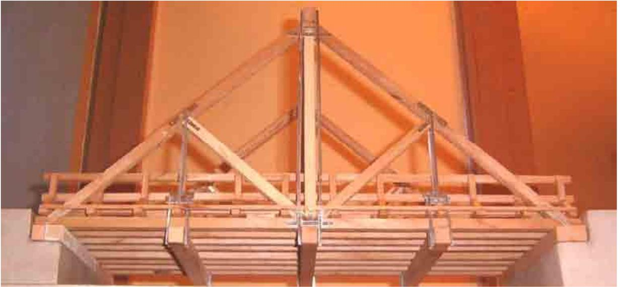
Foto 5: Puente terminado montado sobre estribos.
