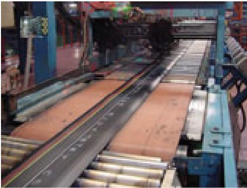
introduce el material en unas máquinas de extrusión donde se fabrica tanto banda de rodamiento como los costados, que requieren dos compuestos diferentes de goma. El resultado es una tira de goma que más tarde se enfría y se corta en función del neumático del que se trate.
