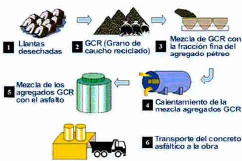
Fig.7: Proceso de mezclado por vía seca.
