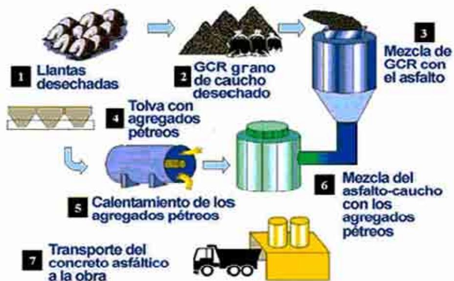
Fig.6: Proceso de mezclado por vía húmeda.
