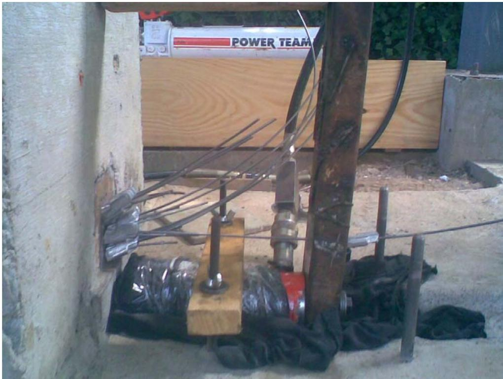
(Fotografía 8.12) Sistema de tensado de los alambres.
