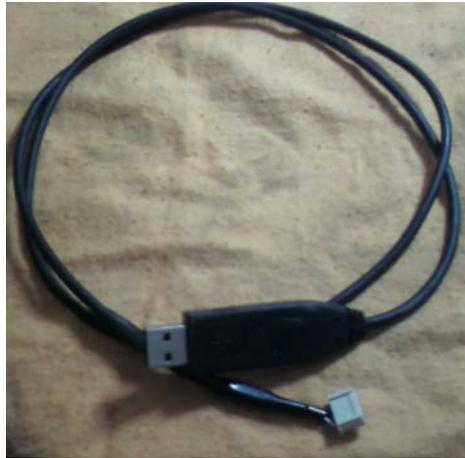
Figura 3.4: Cable de conexión serial
