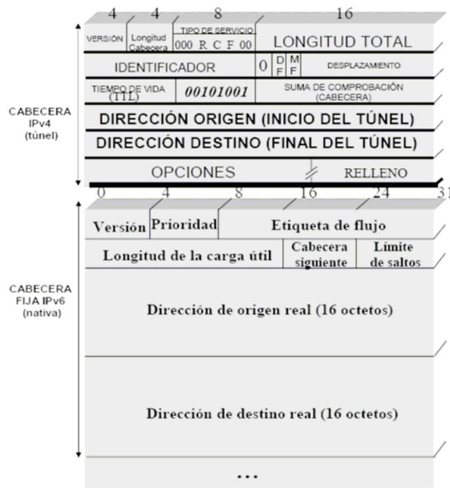
Figura 2.14: Encapsulación de IPv6 sobre IPv4.
