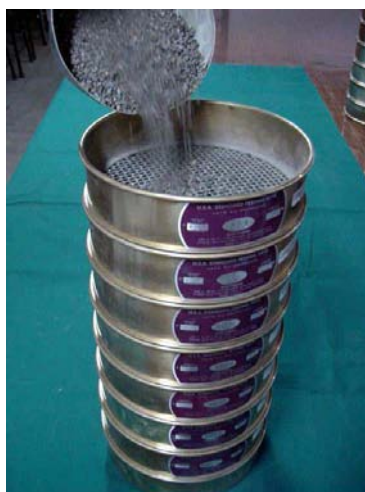
Figura A.1: Tamizado del árido en una serie de mallas. (Fuente: Elaboración propia)
