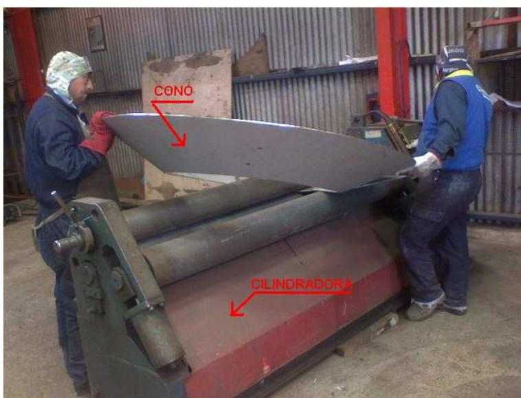
Fig. 30 Cilindrado cono
