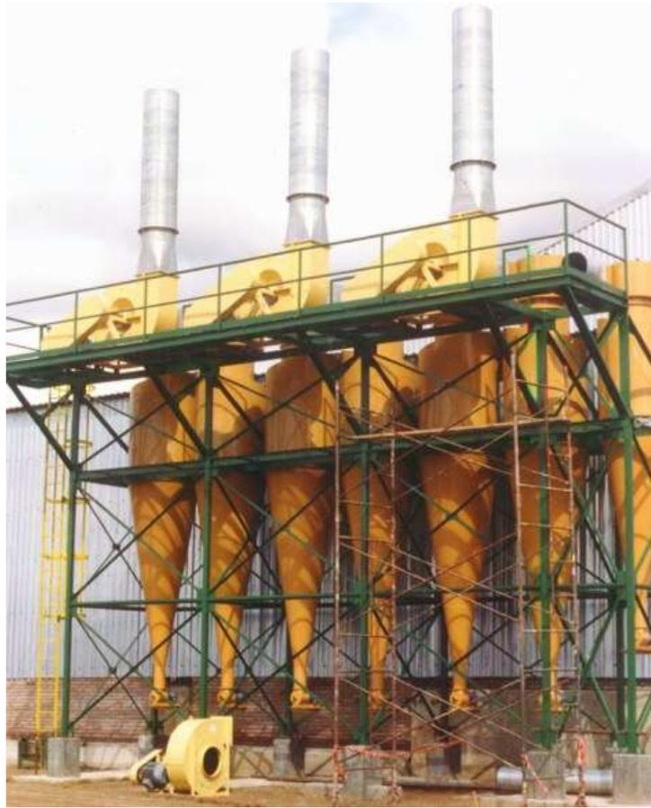
Fig.12 Muestra la operación de ciclones en paralelo
