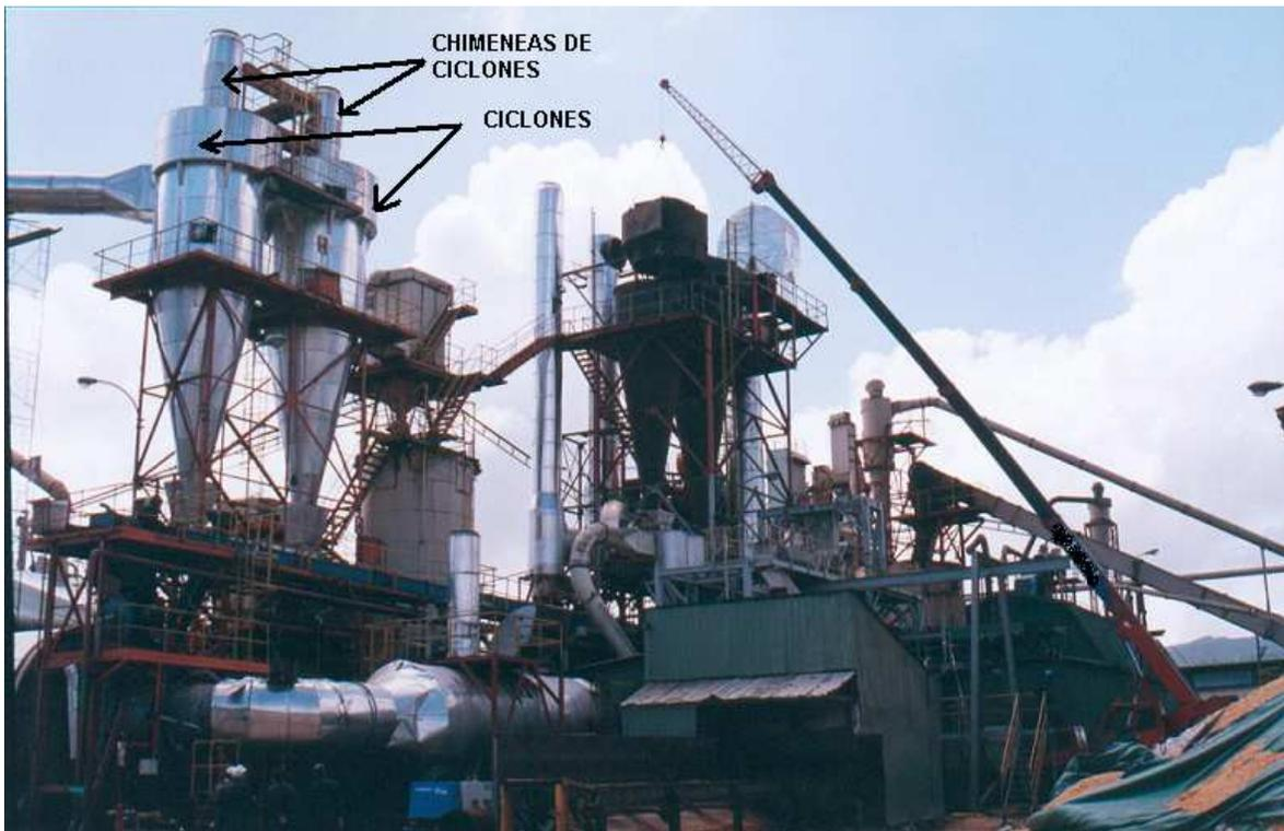
Fig. 38 Ciclonos montados en una planta
