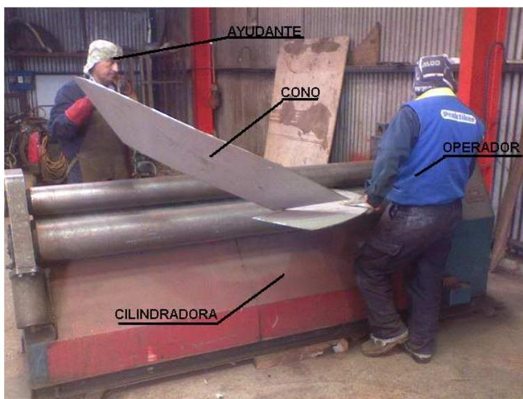
Fig. 28 Cono cilindrándose vista lateral
