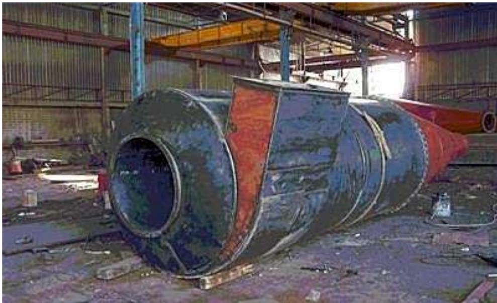
Fig.10 Ciclón de entrada tangencial y descarga periférica
