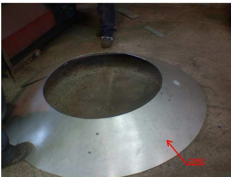
Fig. 31 Cono terminado de cilindrado
