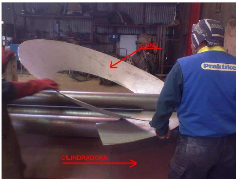
Fig. 29 Cilindrado de cono vista frontal
