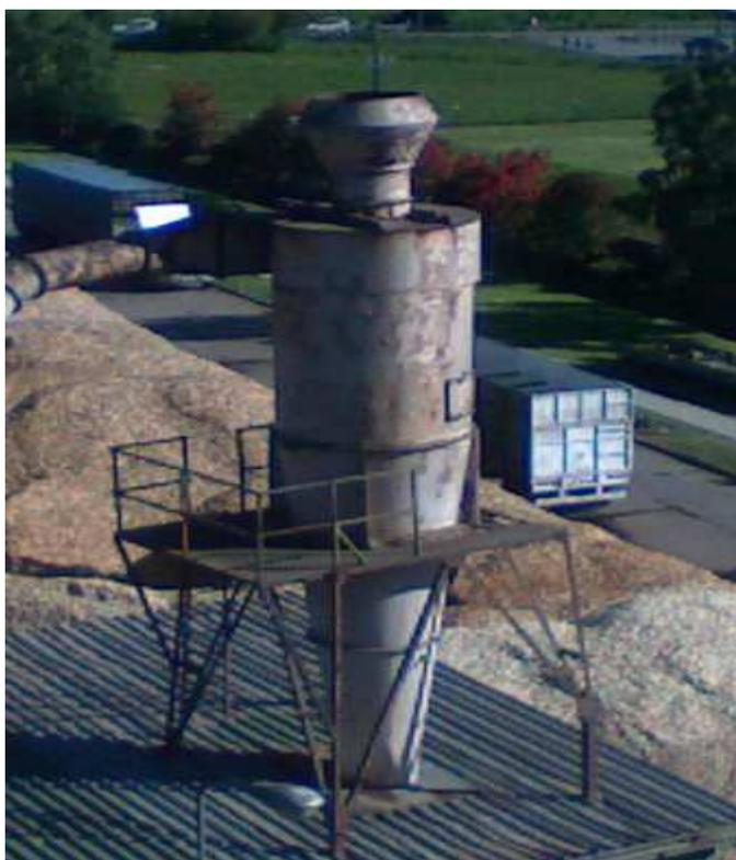
Fig. 8 Ciclón de entrada tangencial y descarga axial
