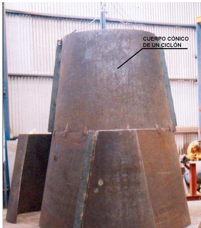
Fig. 35 Muestra la construcción de un ciclón
