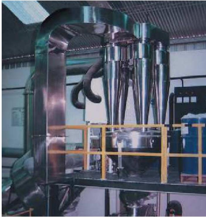
Fig. 9 Ciclón de entrada axial y descarga axial
