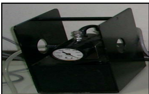
C. Bomba de vacío
