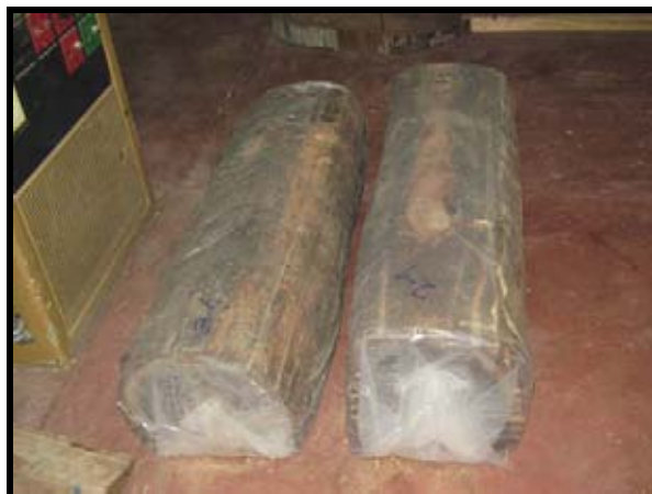
ENVUELTAS PARA EVITAR PERDIDA DE HUMEDAD
