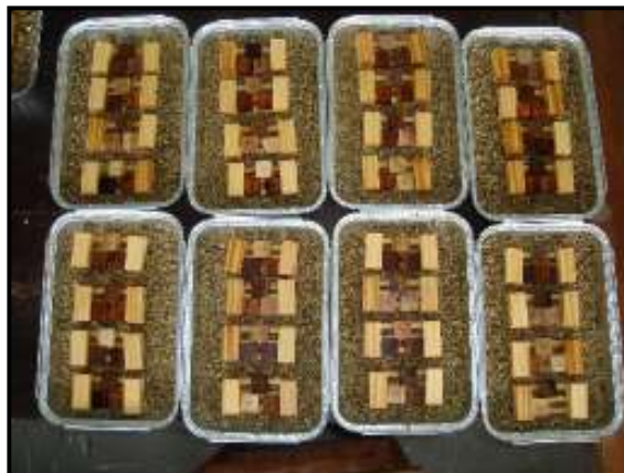
Figura 7 Estructura de P. radiata con probetas en medio de cultivo.
