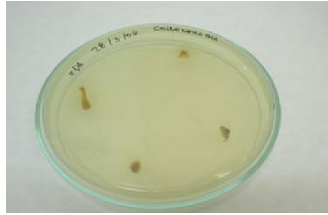
Figura 2. Trozos de madera sembrados en placas Petri con medio de cultivo PDA
