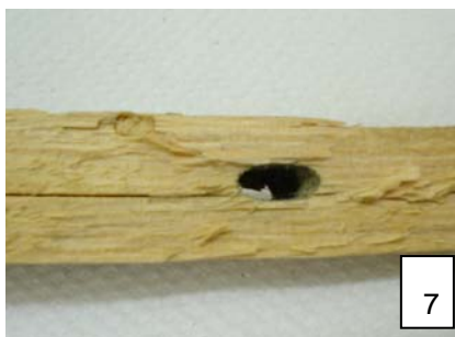
Figura 7 y 8. Muestra de madera de embalaje sin pudrición ni mancha y con daño de insectos del orden Coleoptera, familia Cerambycidae
