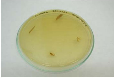
Figura 1. Trozos de madera sembrados en placas Petri con medio de cultivo AEM
