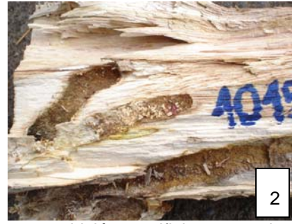
Figura 1 y 2. Muestra de foinque ( Lomatia ferruginea ) con pudrición y orificios causados por Psepholax dentipes
