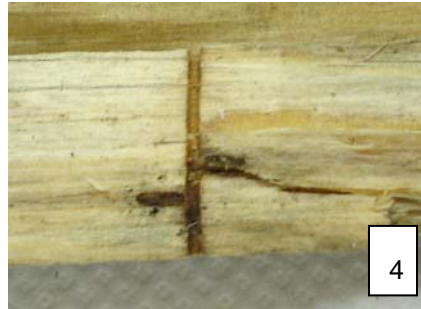
Figura 3 y 4. Muestra de madera de embalaje con mancha y galerías provocadas por insectos del orden Coleoptera, familias Cerambycidae y Scolytidae
