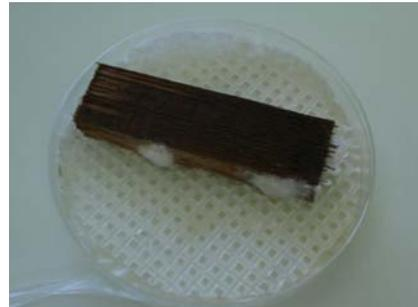
Figura 6. Hongo sembrado en probetas de madera
