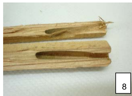
Figura 7 y 8. Muestra de madera de embalaje sin pudrición ni mancha y con daño de insectos del orden Coleoptera, familia Cerambycidae
