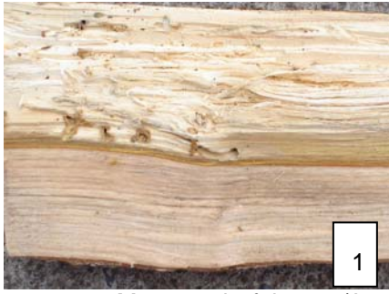
Figura 1 y 2. Muestra de foinque ( Lomatia ferruginea ) con pudrición y orificios causados por Psepholax dentipes
