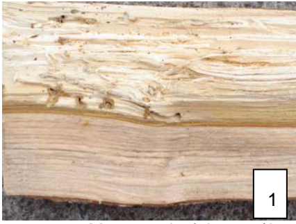
Figura 1 y 2. Muestra de fainque ( Lomatia ferruginea ) con pudrición y orificios causados por Psepholax dentipes
