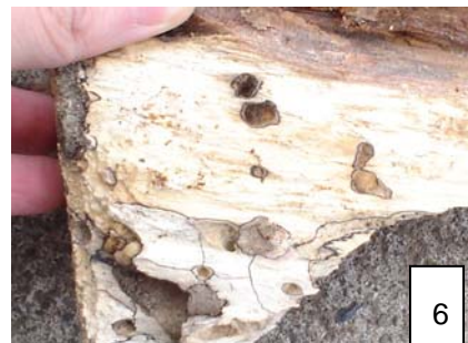
Figura 5 y 6. Muestra de ulmo ( Eucryphia cordifolia ) con mancha y pudrición; y con galerías causadas por Psepholax dentipes
