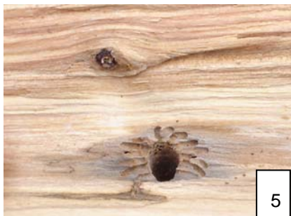
Figura 5 y 6. Muestra de ulmo ( Eucryphia cordifolia ) con mancha y pudrición; y con galerías causadas por Psepholax dentipes
