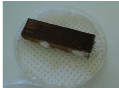
Figura 6. Hongo sembrado en probetas de madera
