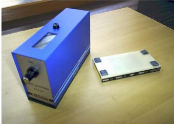
Medidor de adherencia Erichsen (modelo 295)
