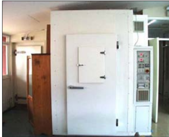
Figura N° 7: Cámara de climatizado
