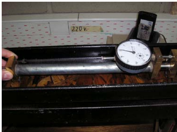
Figura N° 10: Dial para medición de expansión lineal
