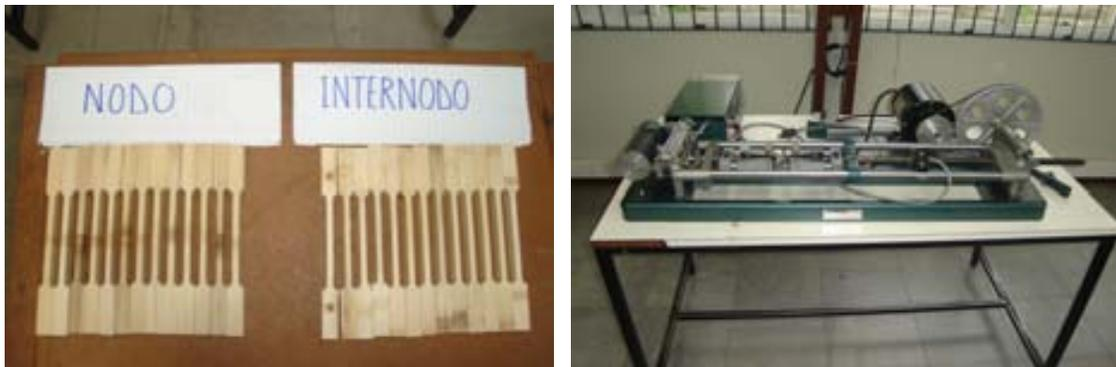
Figura 21. Izquierda: Probetas de *Chusquea Culeou* para ensayos de tracción. Derecha: Máquina universal de ensayos para probetas de tracción
