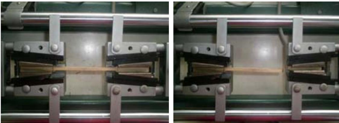
Figura 49. Probeta internodal ensayada
