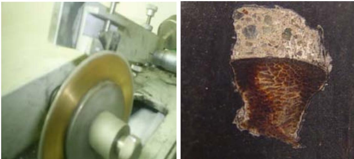
Figura 33. Derecha, montaje y corte de la muestra en el equipo. Izquierda, obtención de la muestra final para análisis microscópico
