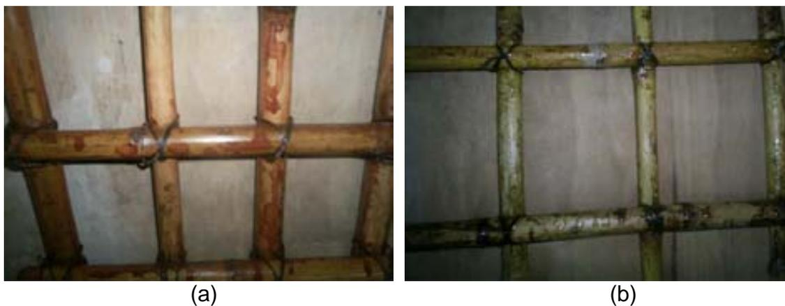
Figura 41. (a) Armadura de *Ch. culeou* recubierta con xyladecor (loseta 1). (b) Armadura de *Ch. culeou* recubierta con silicato de sodio (loseta 2)
