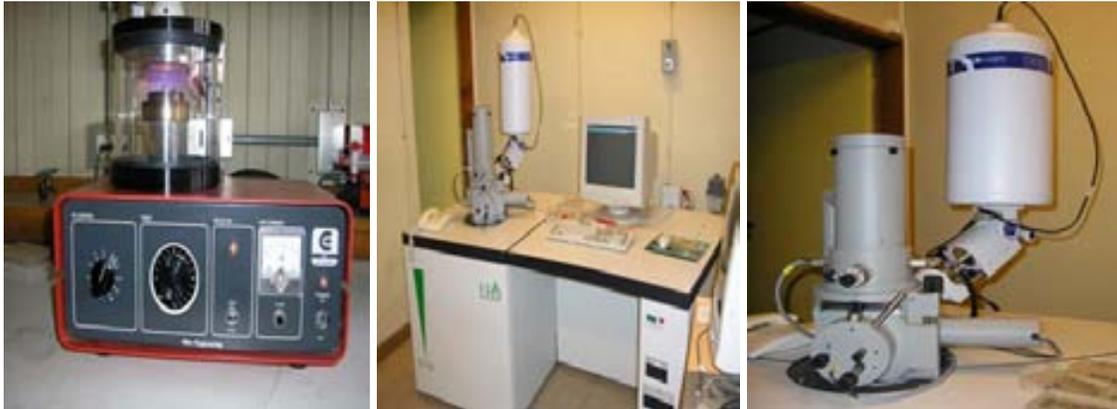
Figura 34. Equipos utilizados para la examinación de muestras a nivel microscópico. A la izquierda se observa el sombreador de oro, al centro y a la derecha el microscopio electrónico de barrido.
