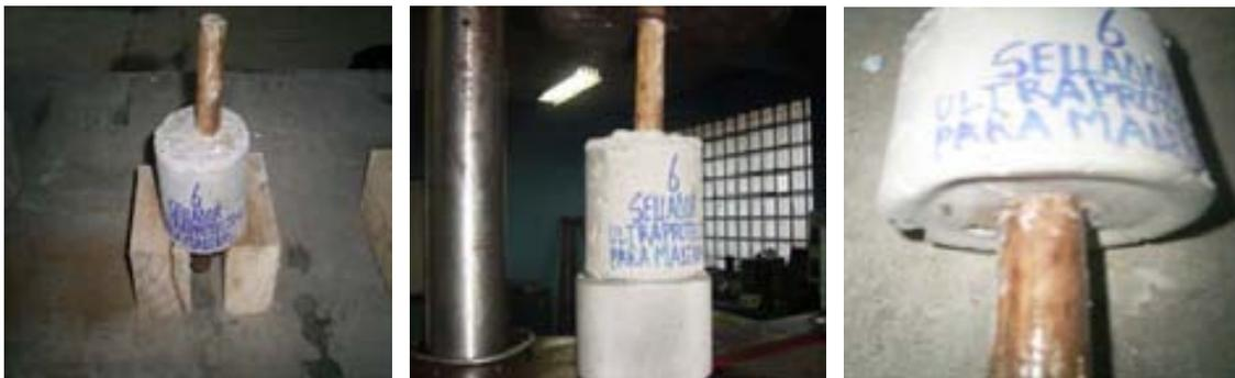
Figura 56. Probeta 6 (Sellador para maderas)
