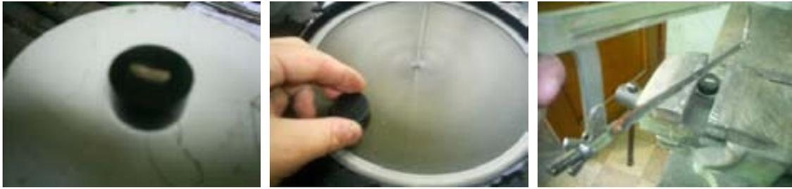
Figura 31. Extracción, pulido y dimensionado de la muestra
