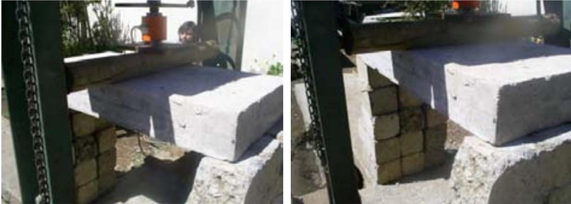
Figura 95. Aplicación de carga sobre loseta 3
