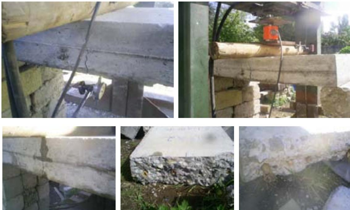
Figura 93. Mecanismo de falla de loseta 2
