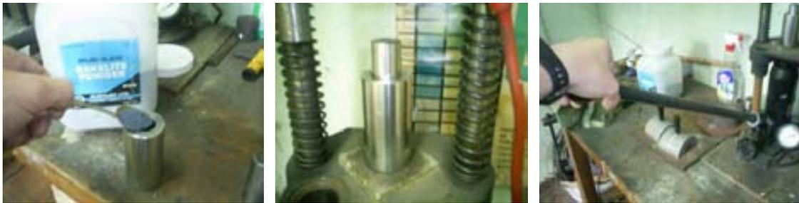
Figura 29. Fijación y tapado de baquelita en cilindro metálico y aplicación de presión.
