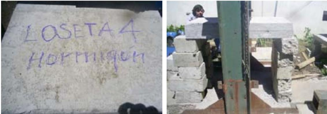
Figura 98. Aplicación de carga sobre loseta 4.
