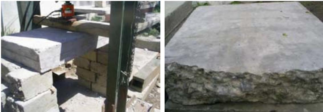
Figura 99. Mecanismo de falla de loseta 4
