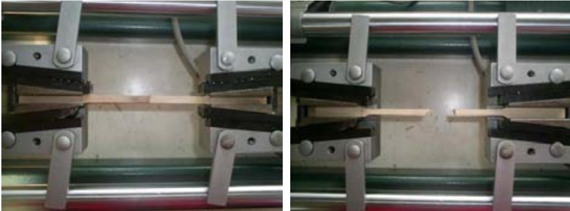
Figura 47. Probeta ensayada con nodo central
