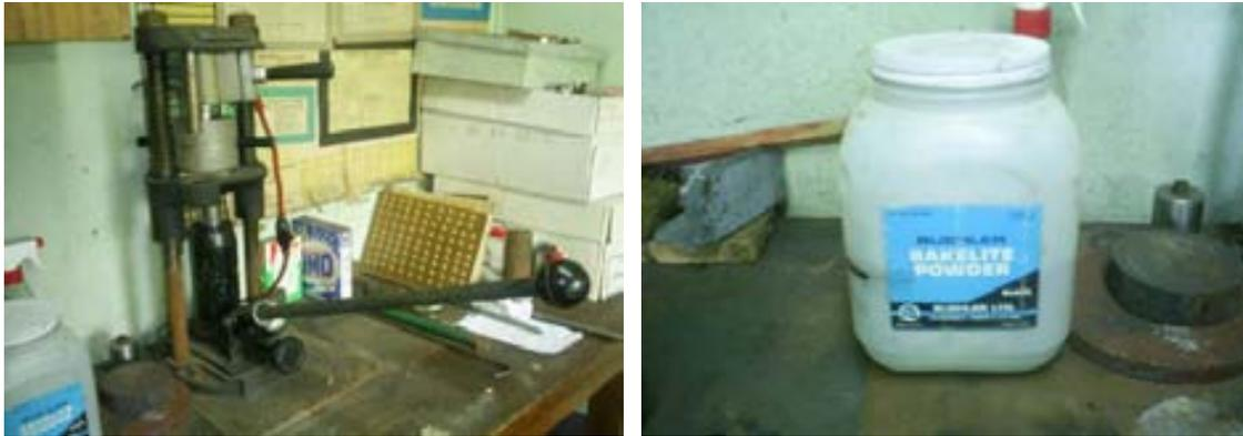
Figura 28. A la izquierda se observa la prensa para la elaboración de muestras a base de baquelita. A la derecha baquelita sólida
