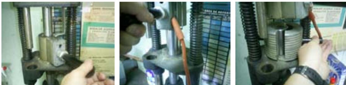
Figura 30. Aplicación y extracción del sistema de temperatura una vez transcurrido el tiempo requerido y colocación de los disipadores de calor
