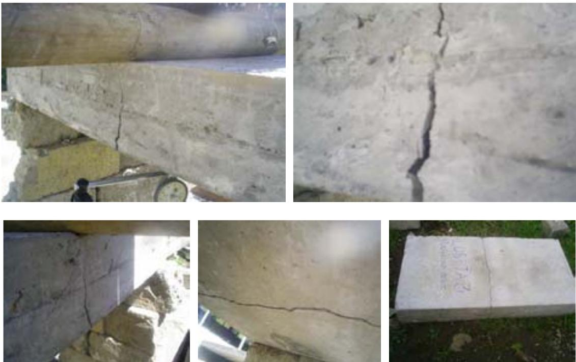
Figura 96. Mecanismo de falla de loseta 3
