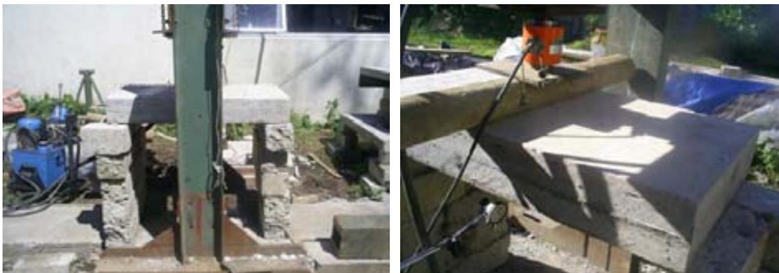
Figura 46. Ensayo de flexo-tracción
