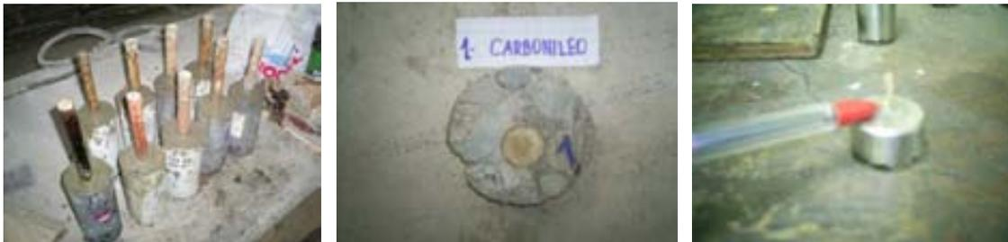
Figura 27. Izquierda: Probetas iniciales para análisis microscópico. Centro: Una de las rodajas cortadas de los cilindros elaborados anteriormente. Derecha: Sección obtenida después de ejecutar el corte correspondiente a la zona de interfase entre colihue-hormigón
