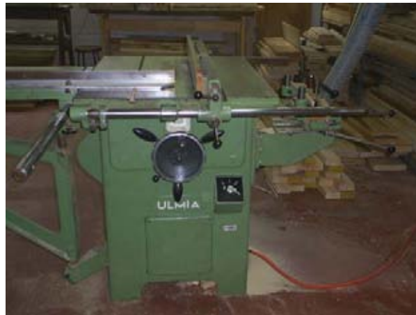
Figura 4. Corte y dimensionado de las piezas a unir.
