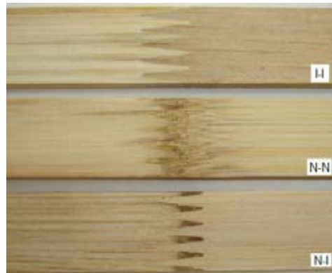
Figura 9. Probetas de uniones con finger 10/11.
