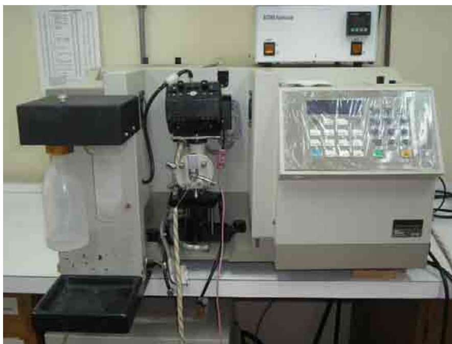
Figura N° 6: Espectrofotómetro de Absorción Atómica, Perkin Elmer, modelo 3110 y un generador de Hidruros.
