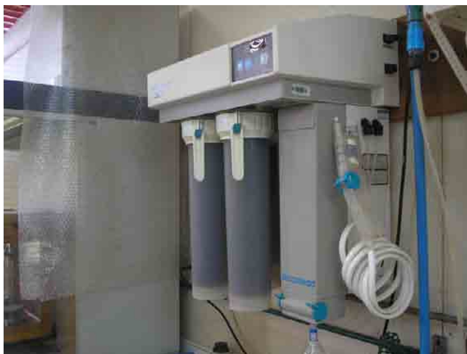
Figura N° 4: Equipo de purificación de agua para obtener agua suprapur libre de iones y minerales.
