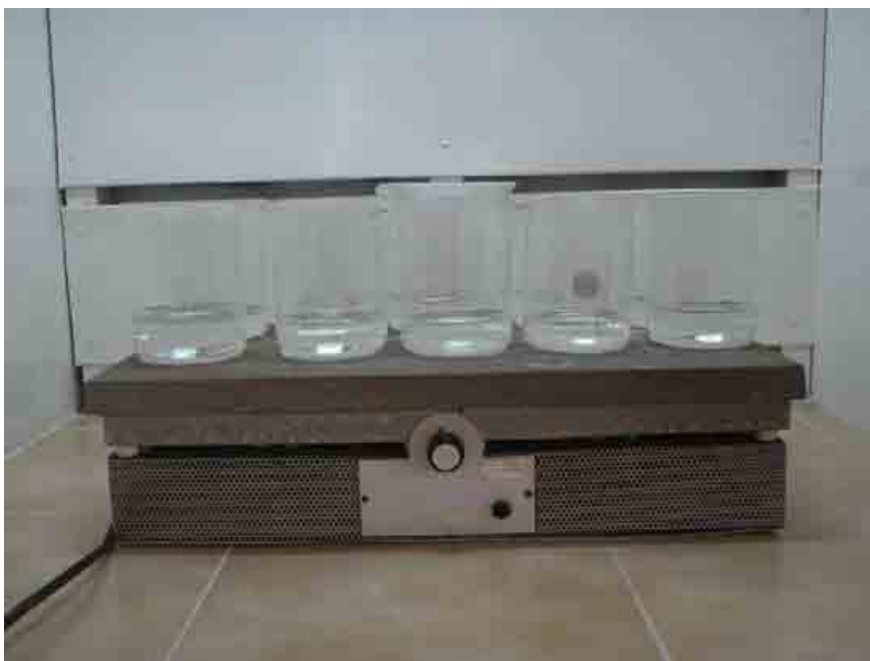
Figura N° 5: Placa térmica, utilizada para evaporar a sequedad las muestras de agua.
