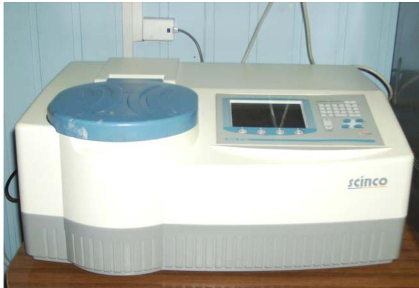
**Figura 8.** Espectrofotómetro SCINCO UV/Visible utilizado para la medición de las absorbancias de pigmentos totales (clorofilas, carotenoides y ficobiliproteínas) presentes en macroalgas y fitoplancton analizadas. Este equipo emplea dos fuentes diferentes de energía para cubrir el intervalo especificado de longitudes de onda. Una lámpara de arco Deuterio suministra la radiación ultravioleta y una de Tungsteno la radiación visible.
