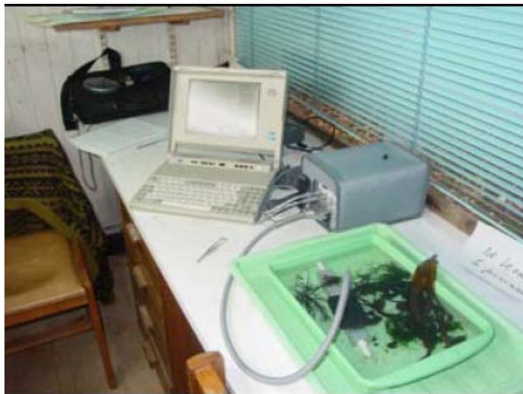
**Figura 10.** Instrumento portátil, PAM 2000. Permite medir la cinética de conversión de energía y parámetros fotoquímicos en el aparato fotosintético *in vivo*.
