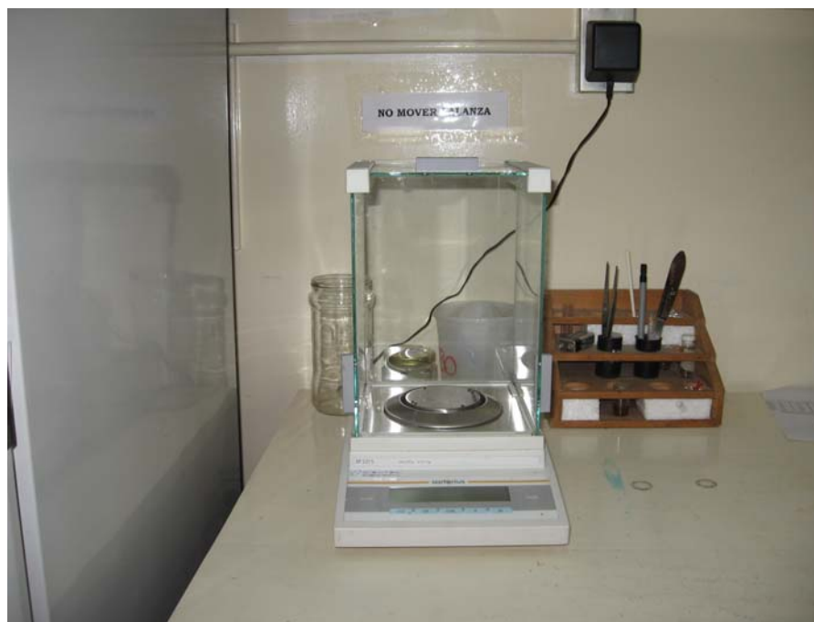
Figura 5: Balanza analítica marca Satorius con precisión 0.01mg.
