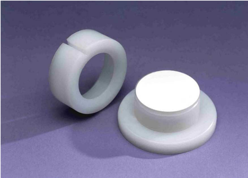
Figura 3: Dispositivo tipo Disco DGT. Se observa en la foto el gel difusor y Chelex 100 sobre el dispositivo de plástico y cubierto por el filtro membrana.
