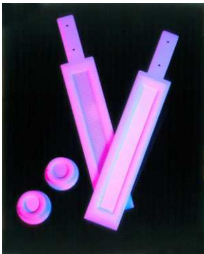
Figura 5: Dispositivos DGT tipo disco para utilizar en muestras de columna de agua y paleta para muestras en sedimento.
