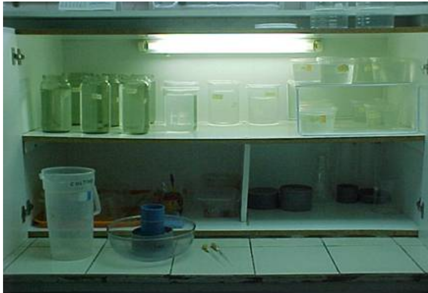
Fig. 2. Cámara de cultivo de dáfidos con temperatura y fotoperíodo controlados.
