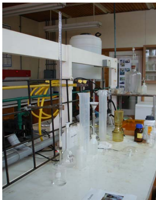
Foto. 2. Columna con resina Poli-4-vinilpiridina.
