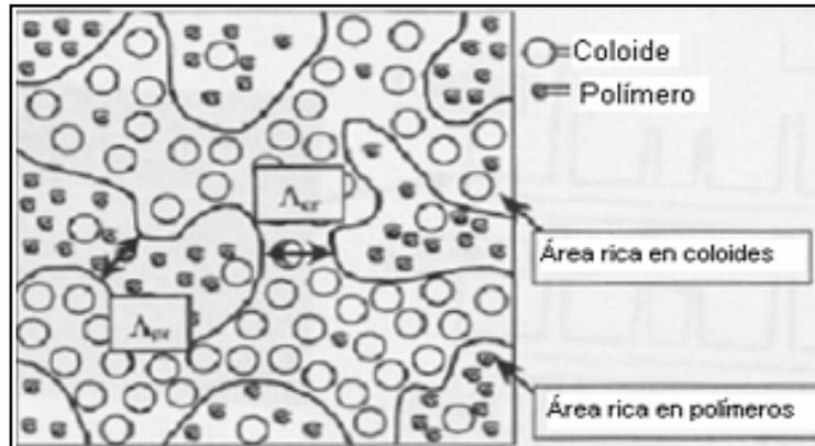
**FIGURA 7. Esquema de separación de fases en el sistema polímero-hidrocoloide.**
