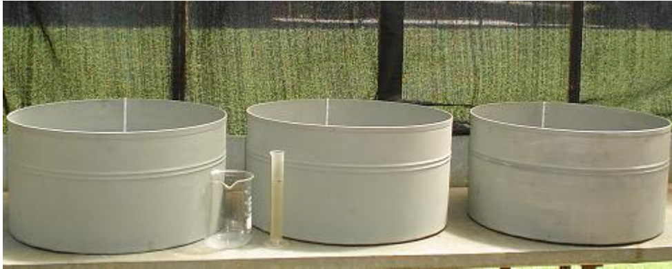
FIGURA 6. Diseño de las bandejas evaporimétricas usadas en el ensayo.
