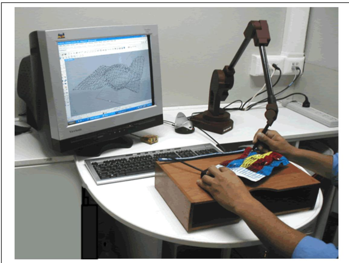
**FIGURA 41. Captura de los puntos de la malla trazada sobre las bolsas esterilizables con el brazo digitalizador Microscribe-3DL™.**
