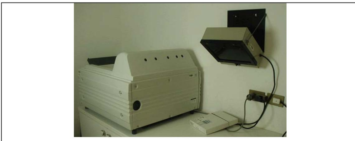
**FIGURA 30. Reveladora automática Modelo XP 1000 DAITO.**
