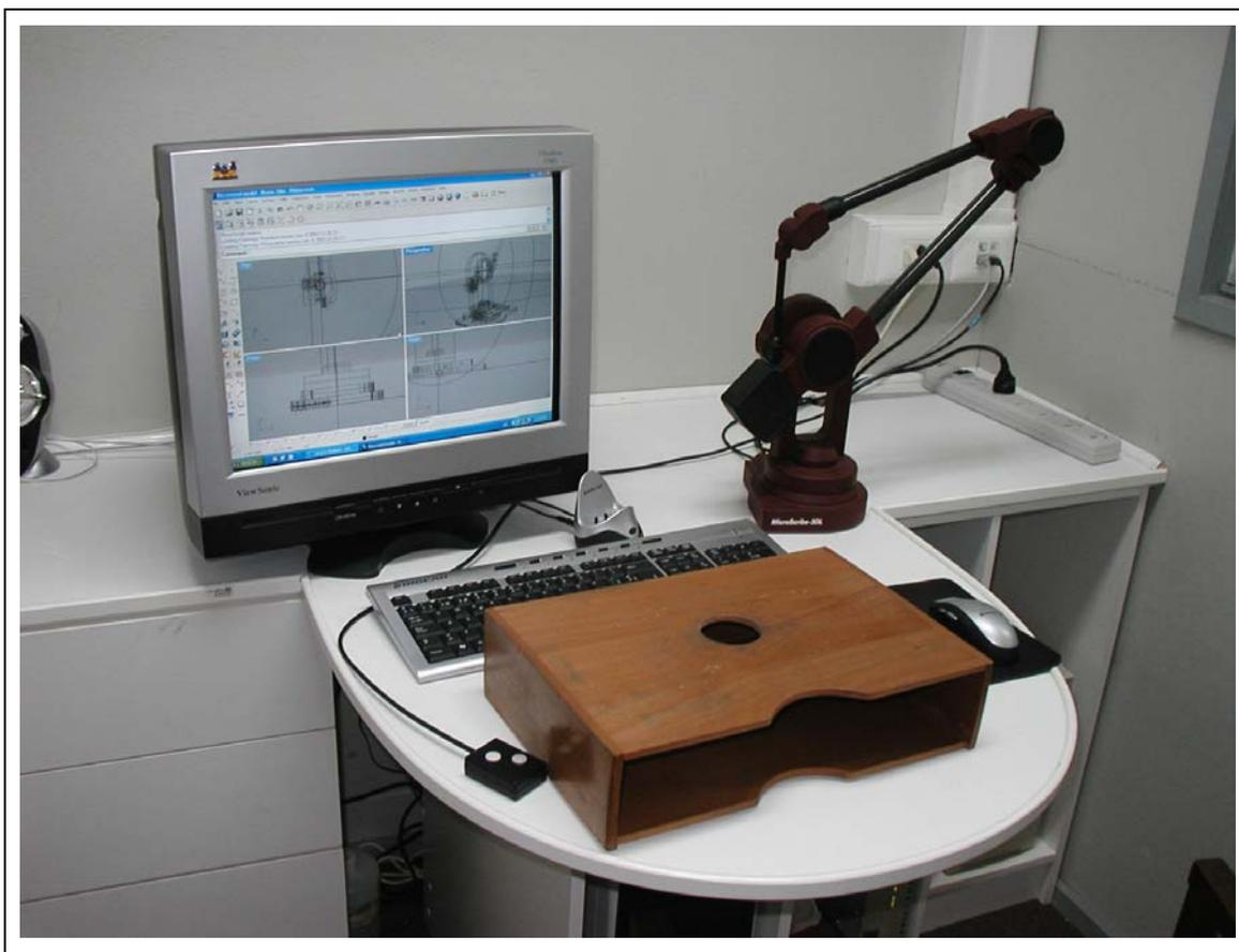
**FIGURA 40. Plataforma de soporte para la digitalización tridimensional de los trozos de jurel envasados al vacío en bolsas esterilizables.**
