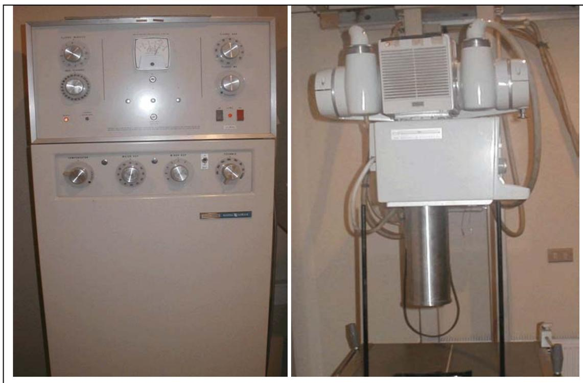
**FIGURA 29. Equipo de rayos X Modelo DXD – 350 II General Electric.**
