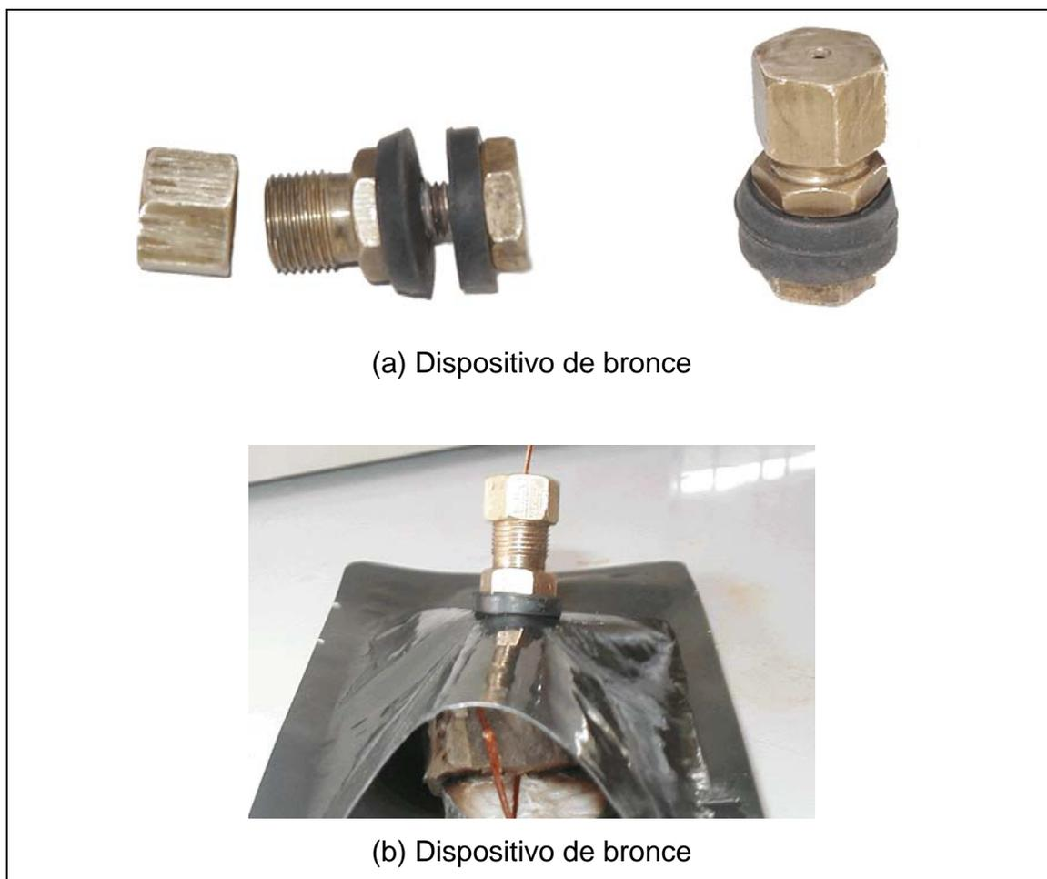
**FIGURA 27. Dispositivo de bronce para el paso de termocuplas al interior de la bolsa esterilizable.**
