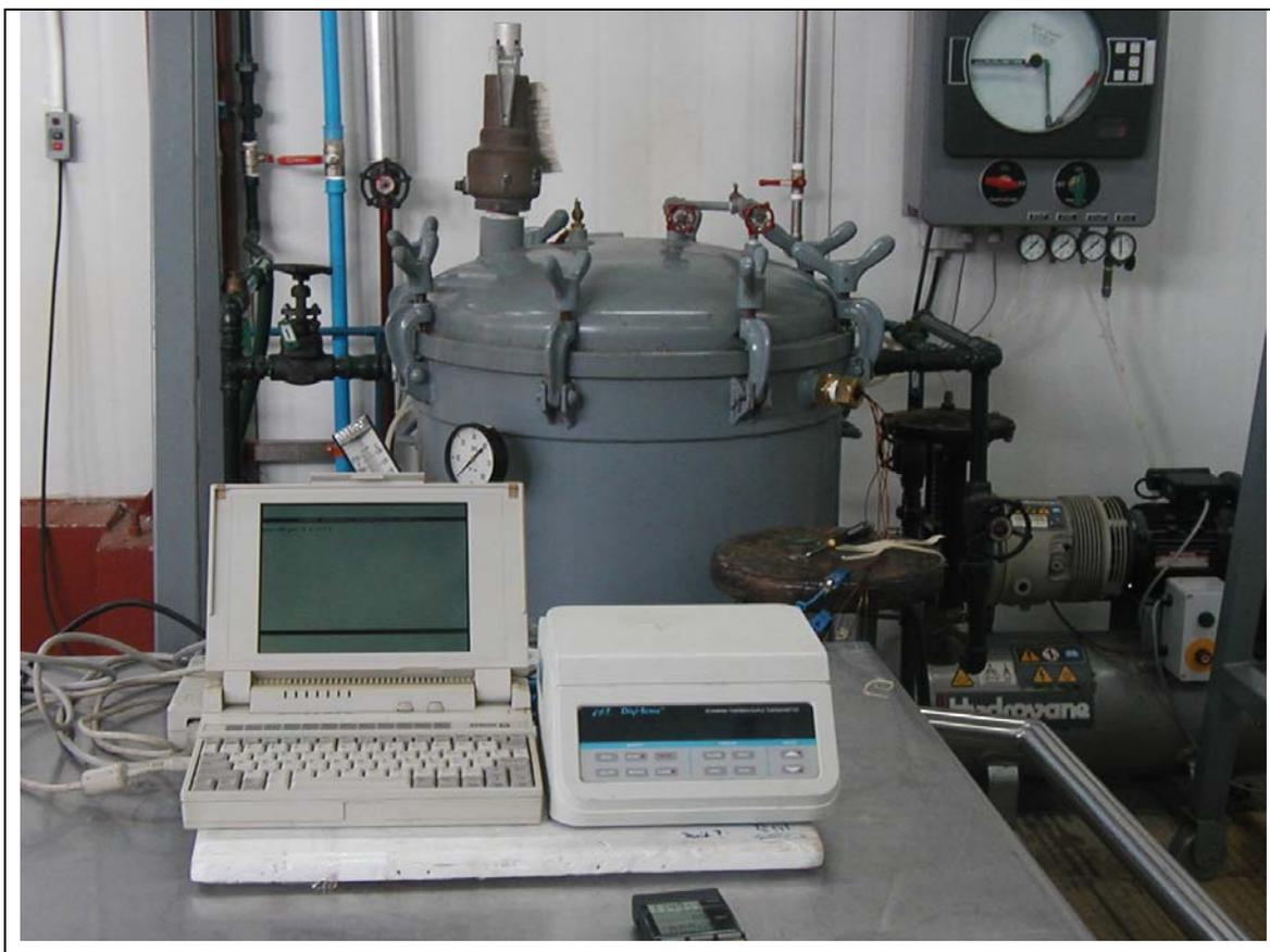
**FIGURA 34. Equipamiento de esterilización y sistema de adquisición de datos.**
