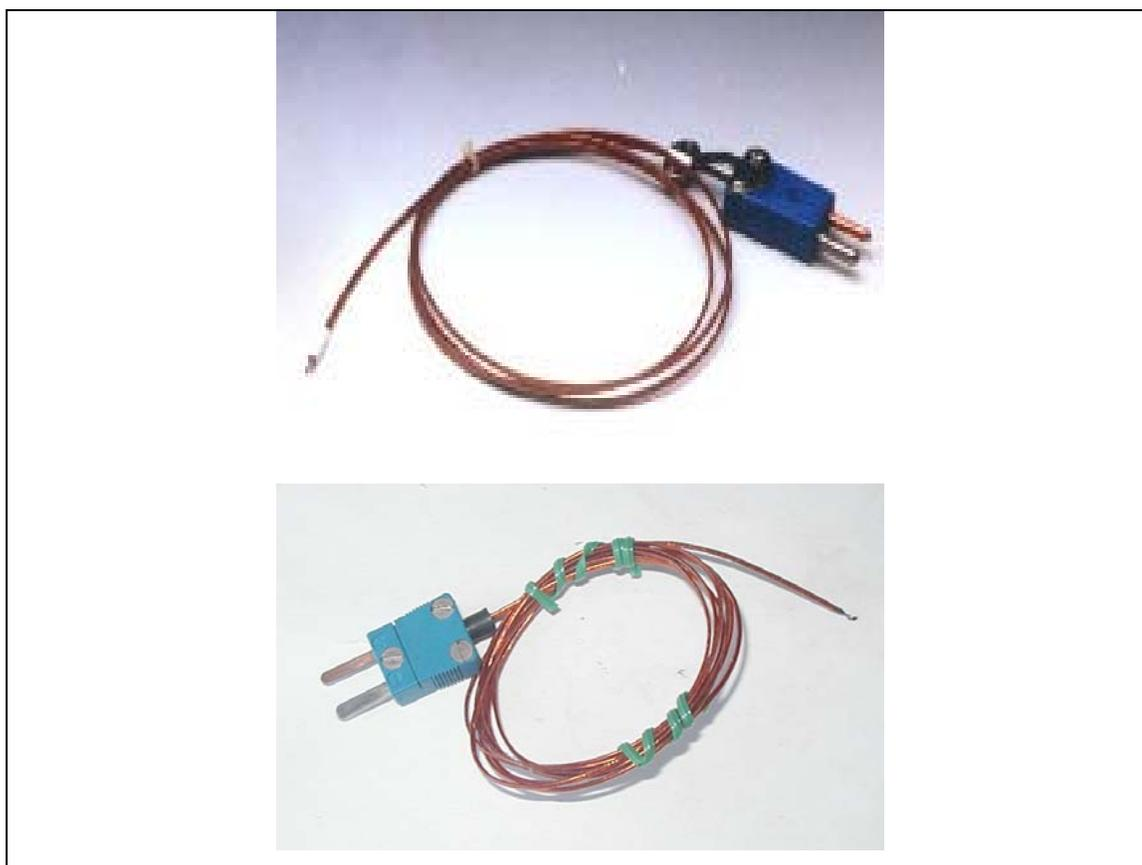
**FIGURA 26. Termocuplas tipo T Kapton® calibre 30.**
