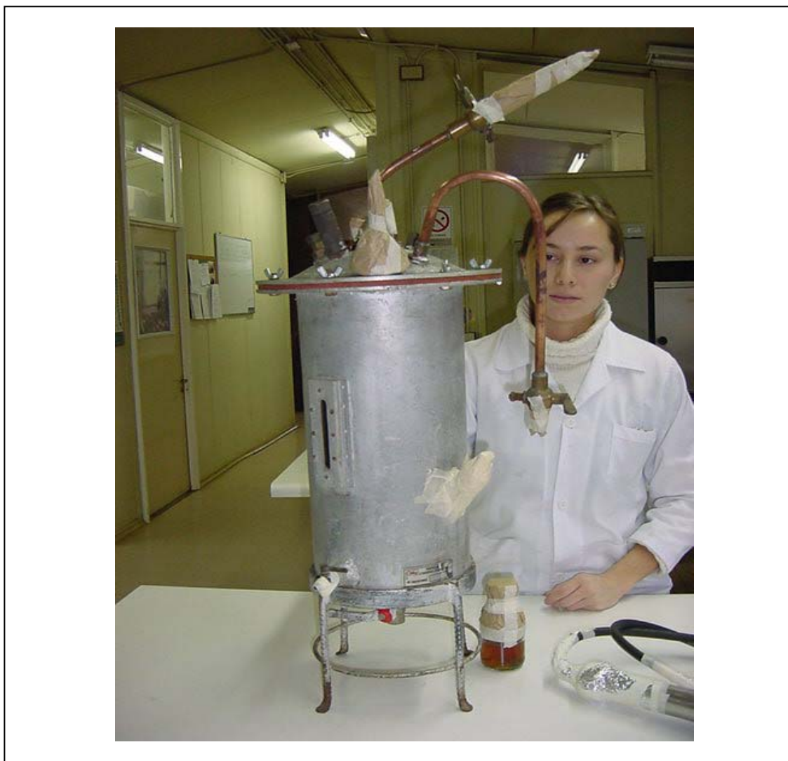
FIGURA 6 Fermentador artesanal capacidad 9L, propiedad de levaduras Collico prestado para realizar la fermentación.
