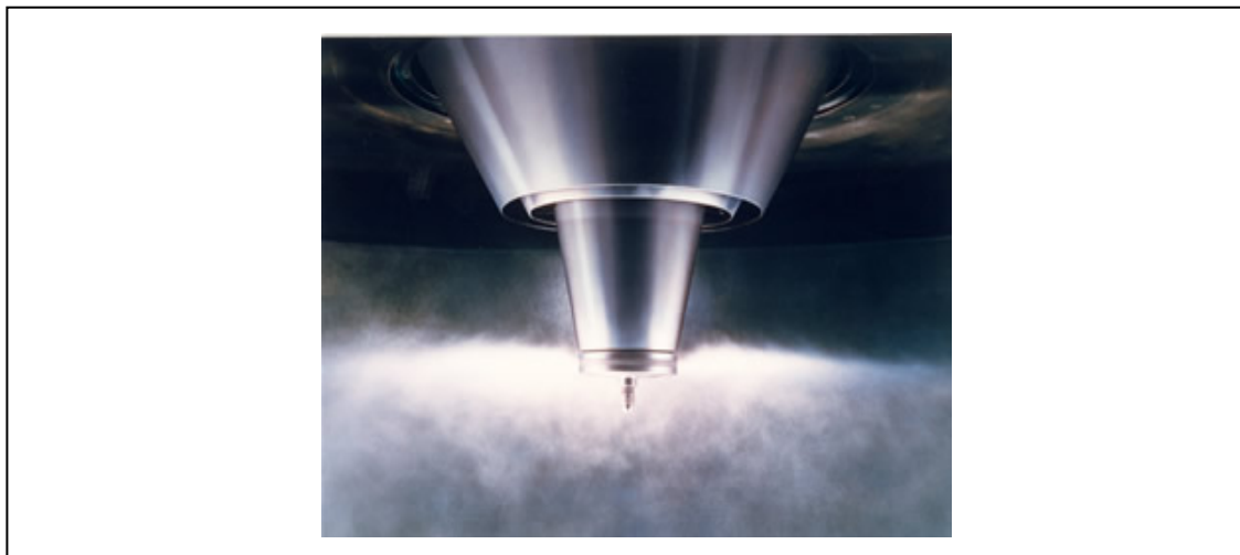
FIGURA 3 Formación de microgota o neblina en un atomizador rotatorio impulsado por aire comprimido. 4
