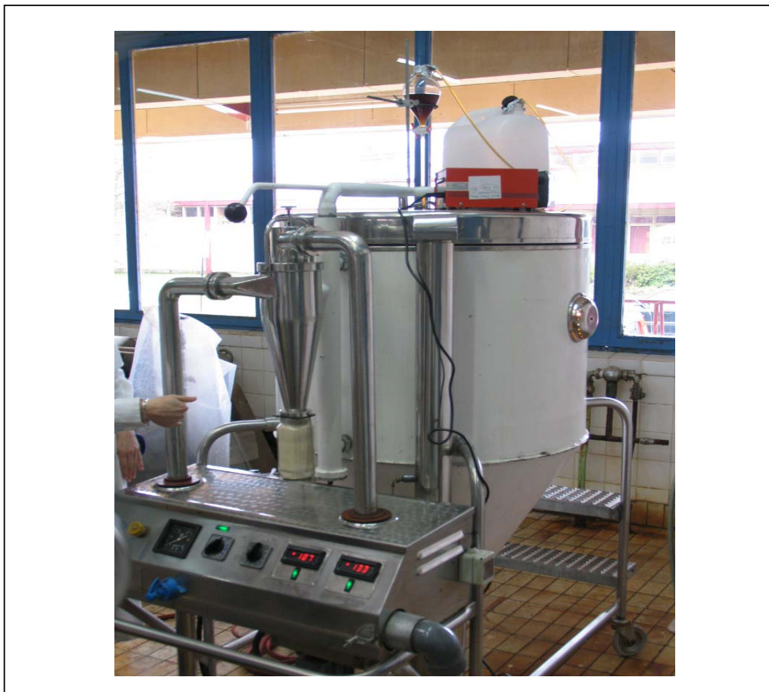
FIGURA 7 Secador Spray Niro Atomizer propiedad del Instituto de Ciencia y Tecnología de los Alimentos (ICYTAL) de la Universidad Austral de Chile.
