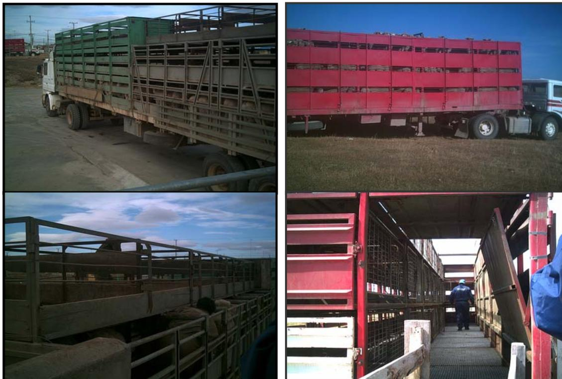
**FIGURA 24 Comparación entre camiones con jaulas antiguas (izquierda), frente a diseños de jaulas utilizadas actualmente (derecha).**
