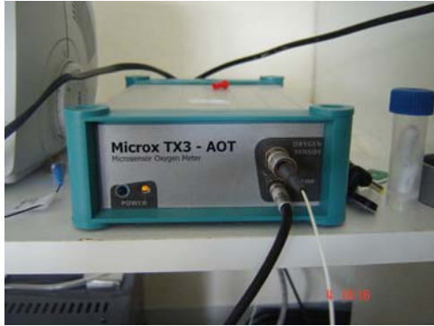
Figura 6: Equipo Presens al cual se conecta el sensor de flujo continuo.
