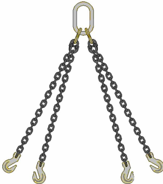
Fig. 4.07 Eslingue de cuatro puntas para el retiro de los paneles./Elaboración
