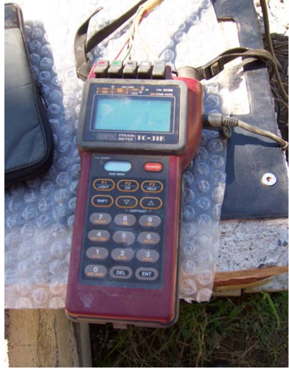
Fotografía 5.4 Lector de carga.
