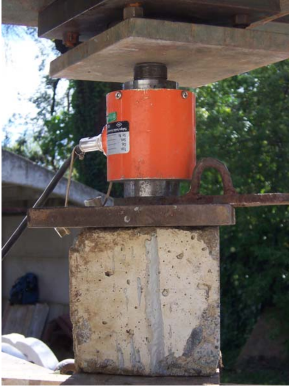
Fotografía 5.1 Celda de carga.
