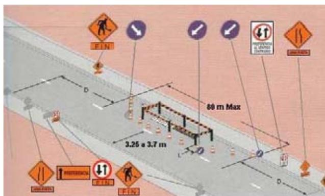
**Figura N° 42.**Control de tráfico por medio de señales que indiquen preferencia
