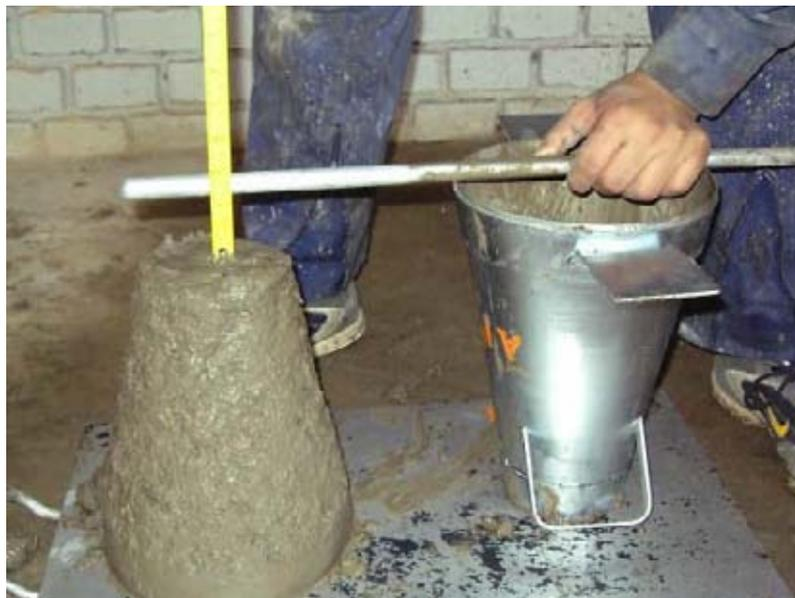
Figura N° 10.- Medición del Cono de Abrams.
