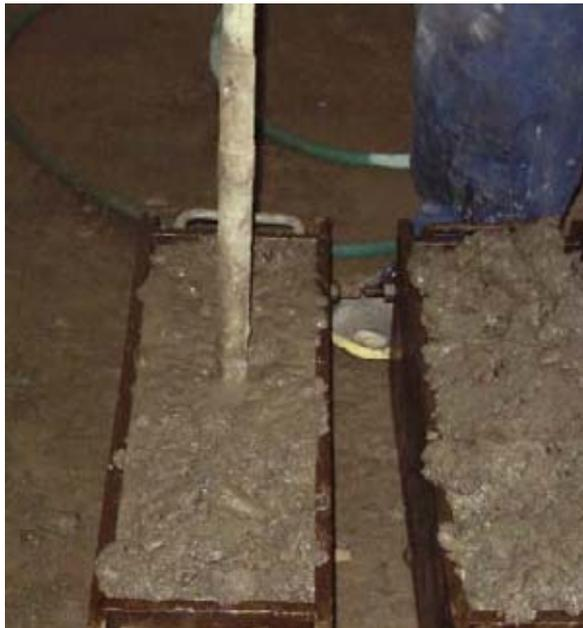
Figura N° 11.- Compactación con vibrador.
