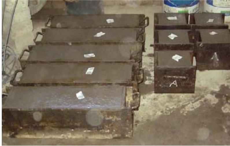
Figura N° 12.- Acabado e identificación de moldes.
