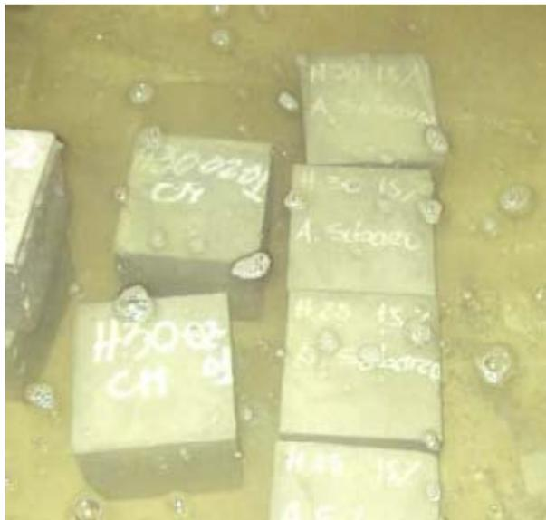
Figura N° 13.- Curado de probetas.
