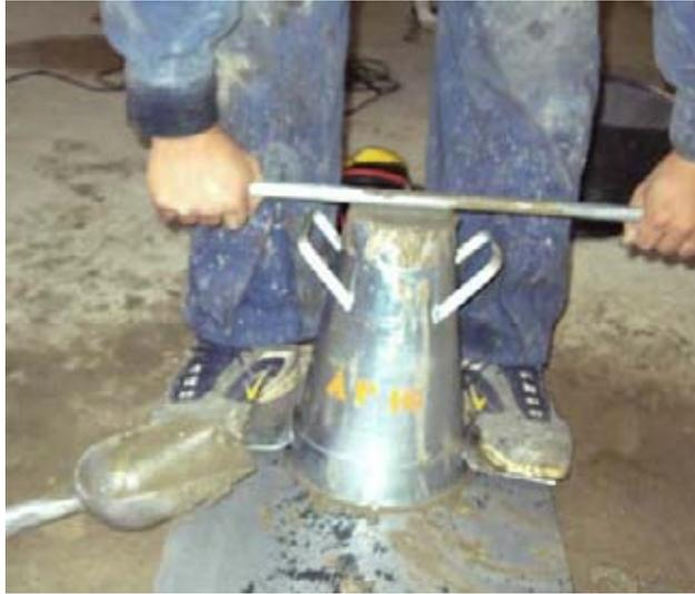
Figura N° 9.- Enrasado del Cono de Abrams.
