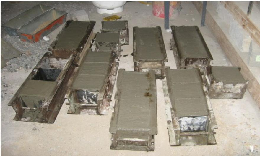
Imagen N°11: Probetas recién construidas.
