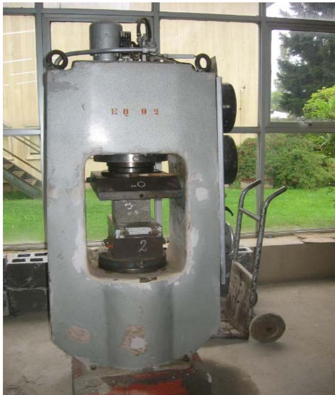
Imagen N°15: Probeta en la maquina de compresión.
