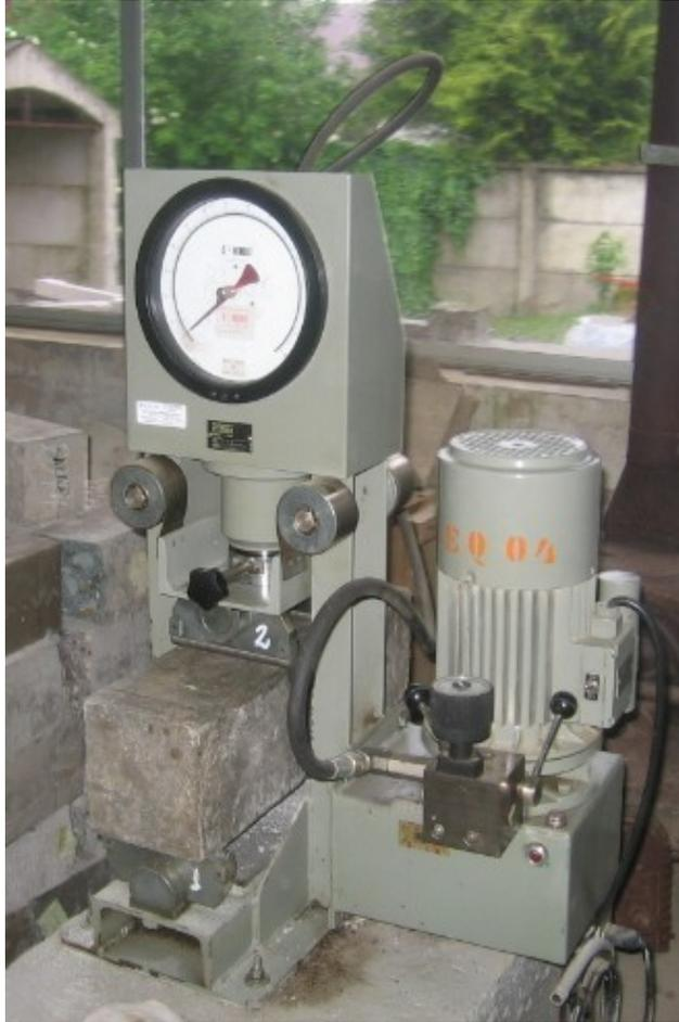
**Imagen N°18: Ensayo de probetas a flexotracción.**
