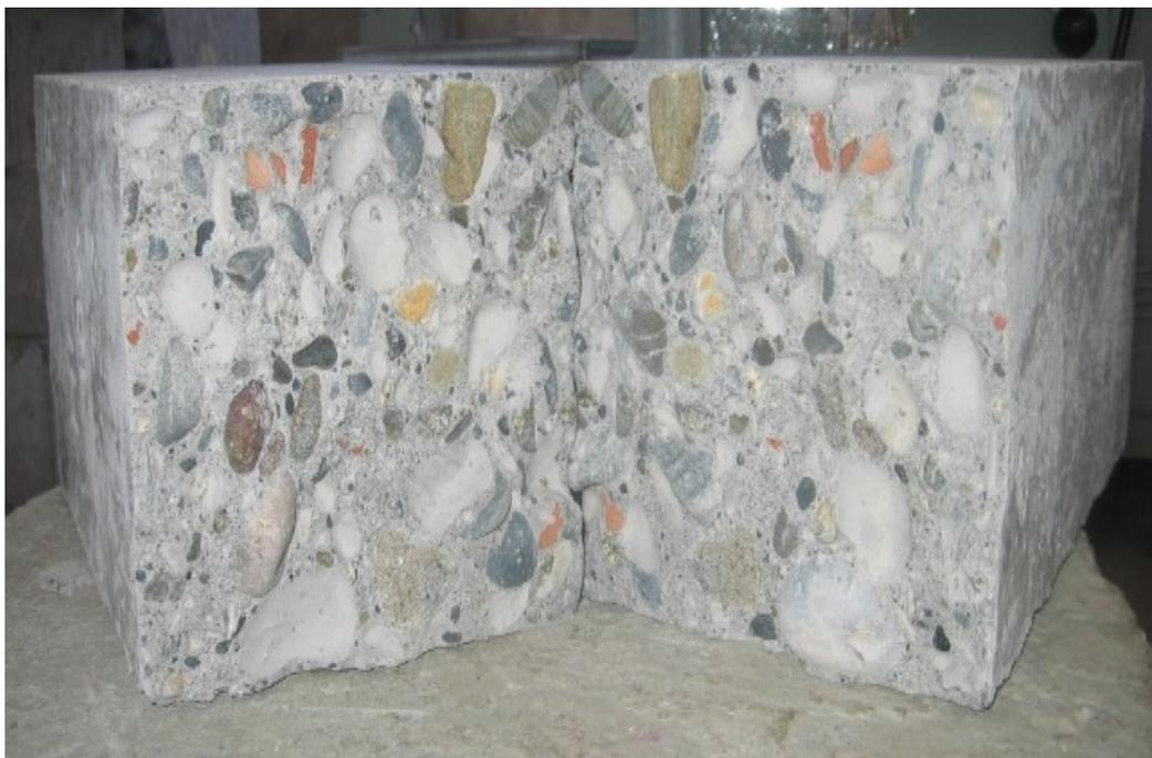
**Imagen N°19: Probetas después de ser ensayadas a flexotracción**
