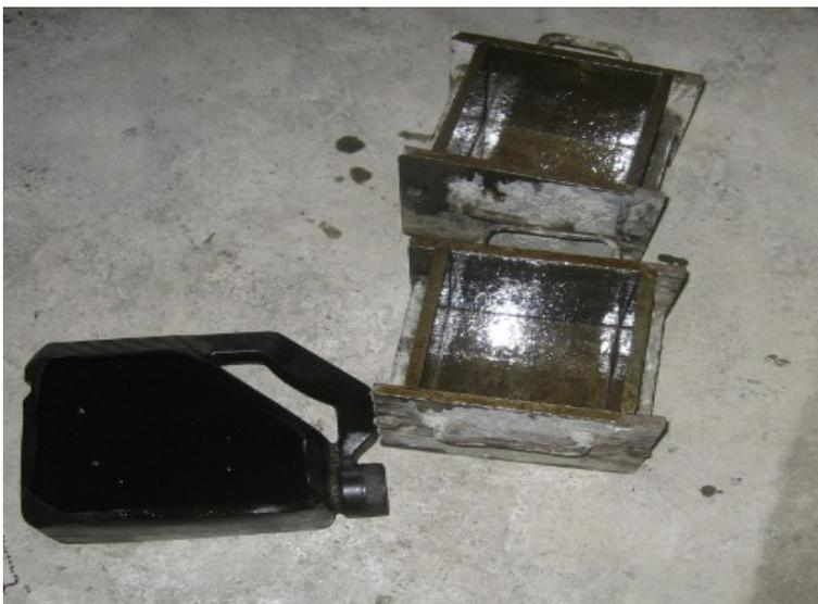
Imagen N°10: Moldes cúbicos de 15 x 15 cm. Provistos de una capa desmoldante.
