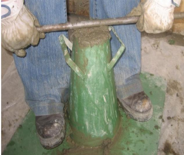
medio de la utilización del cono de Abrams según lo especificado en la norma NCh 1019 Of 74.
