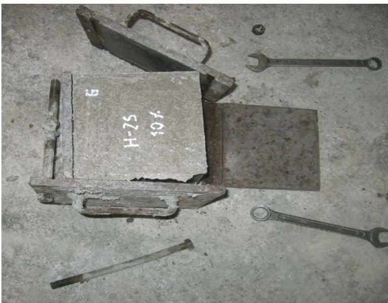
Imagen N°12: Desmolde de probetas.
