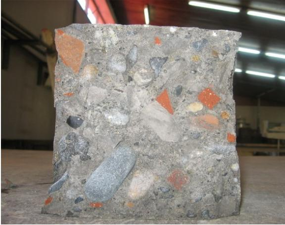
**Imagen N°17: Probeta ensayada con 20% albañilería reciclada.**
