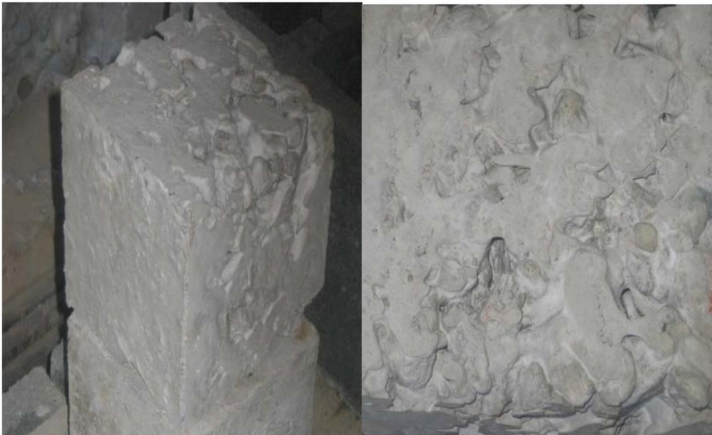
**Imagen N°9: Probetas construidas con altos % de áridos reciclados.**
