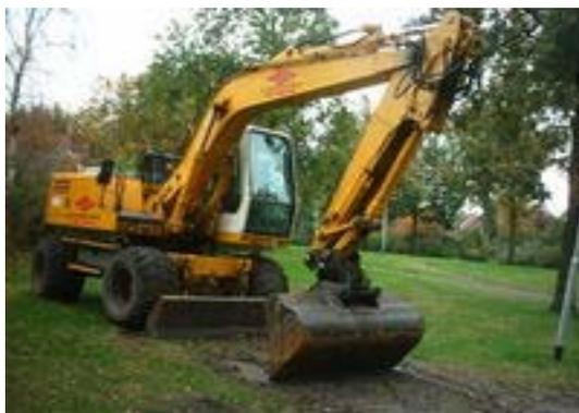
**Fig. N° 14. Pala Excavadora montada sobre llantas.**
