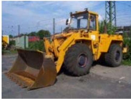
**Fig. N° 23. Cargador frontal sobre llantas.**
