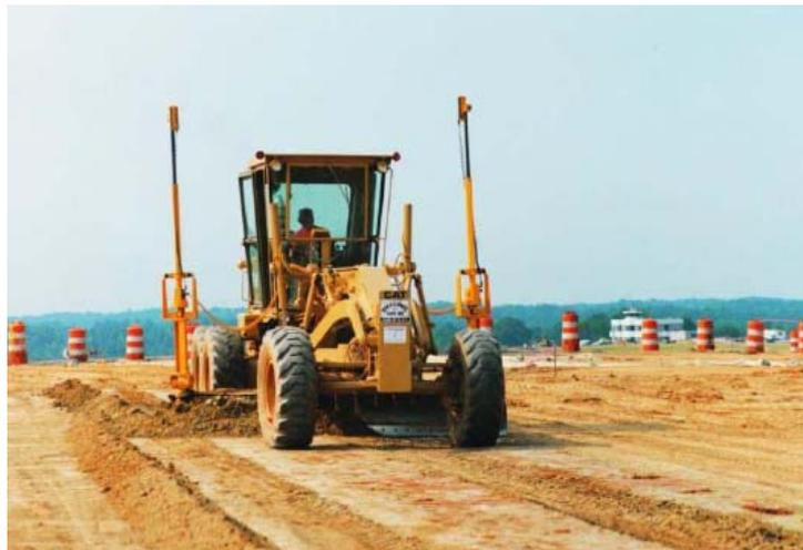
**Fig. N° 36. Sistema Láser automático para Motoniveladora; configuración de dos mástiles instalado en cada extremo de la hoja para control de pendiente longitudinal y transversal.**
