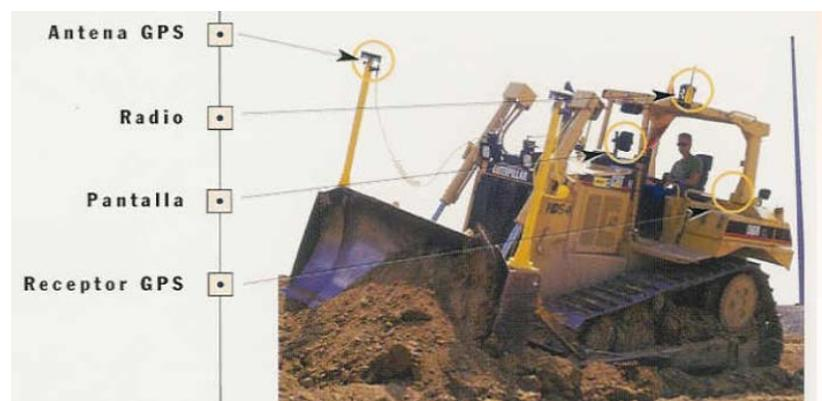
**Fig. N° 42. Esquema que demuestra como trabaja el sistema.**
