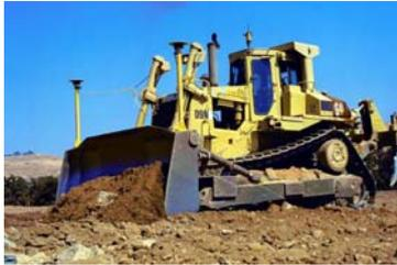
**Fig. N° 45. Bulldozer con sistema GPS.**
