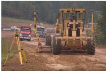
**Fig. N° 44. Motoniveladora con sistema GPS + Láser.**
