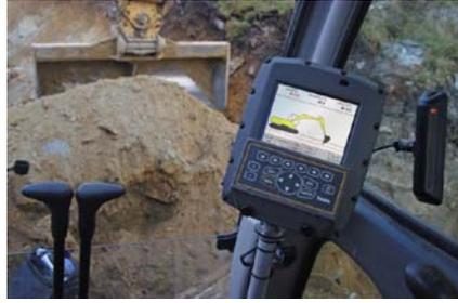
Fig. N° 55. Pantalla del operador del sistema GPS.
