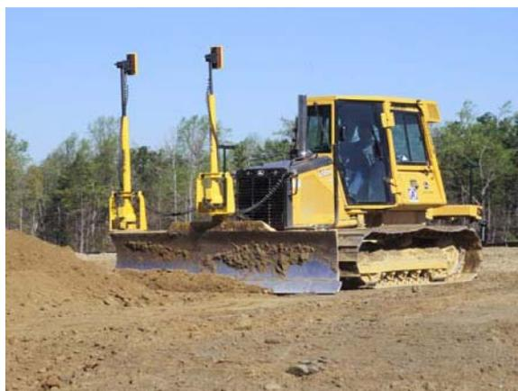
**Fig. N° 34. Sistema Láser automático par Bulldozer; configuración de dos mástiles instalados uno en el centro y el otro a un costado de la hoja de corte para control de doble pendiente.**
