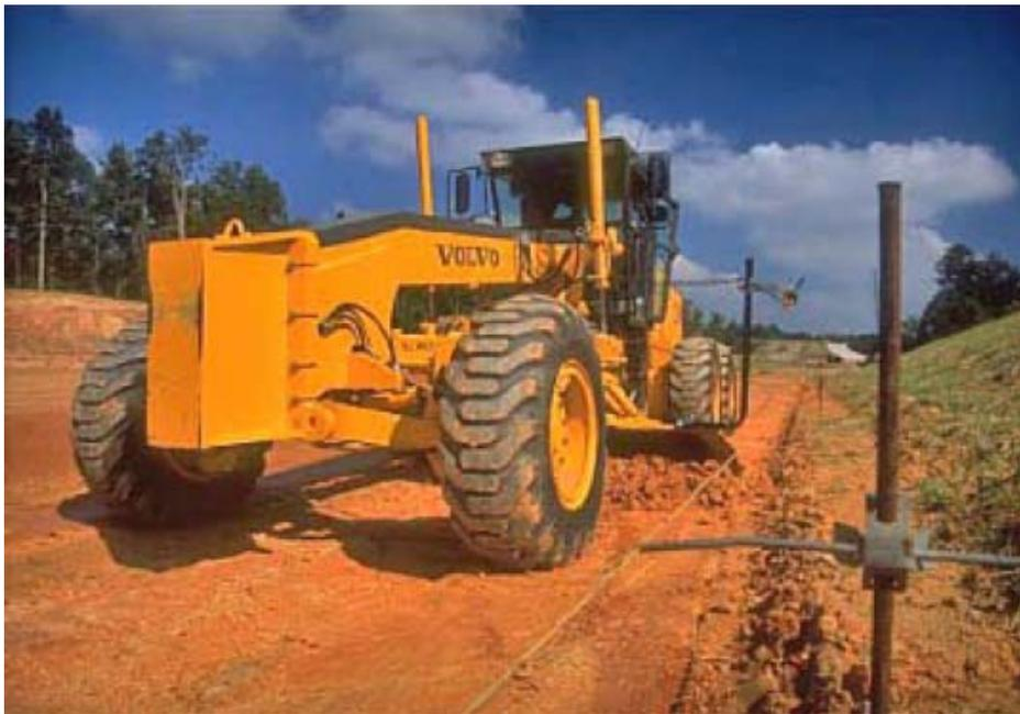
**Fig. N° 27. Motoniveladora con Sistema Ultrasonido siguiendo la referencia de la lienza.**
