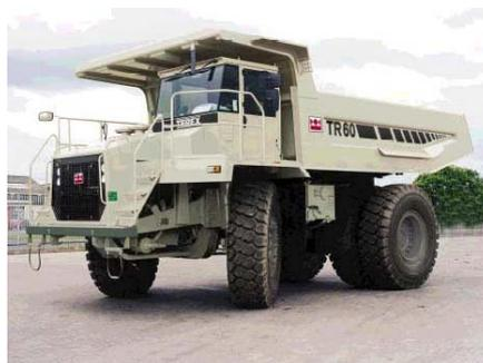
**Fig. N° 24. Dúmpfer Terex serie TR60**
