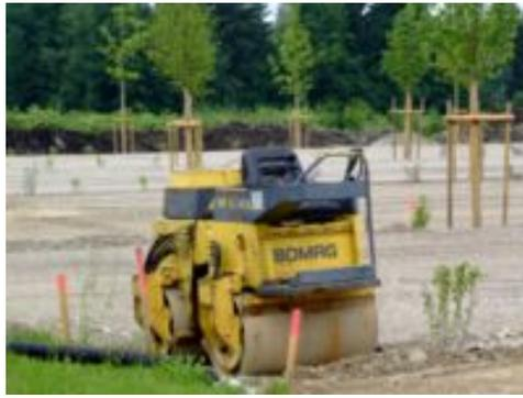
**Fig. N° 21. Rodillo compactador.**
