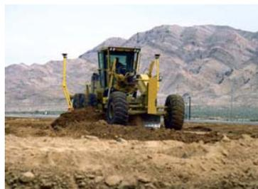
**Fig. N° 43. Motoniveladora con sistema GPS.**
