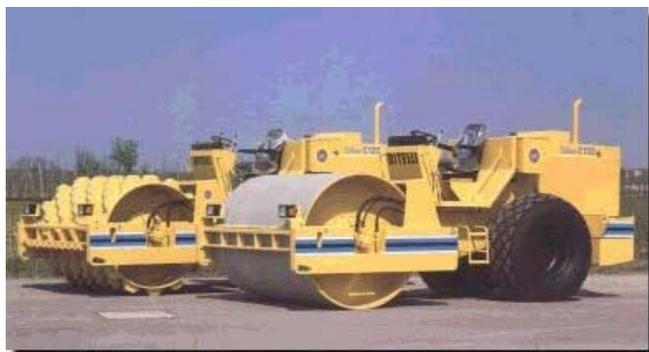
Fig. N° 20. . Compactadoras BITELLI TIFONE C120: de rulo, y de pata de cabra.
