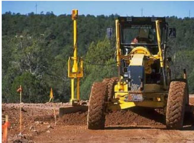
**Fig. N° 35. Sistema Láser automático par Motoniveladora; configuración de un mástil instalado en un extremo de la hoja de corte para control de pendiente longitudinal y un sensor para controlar la pendiente transversal.**
