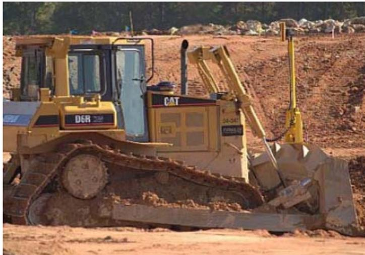
**Fig. N° 33. Sistema Láser automático para Bulldozer; configuración de un mástil instalado en el centro de la hoja de corte para control de pendiente simple.**
