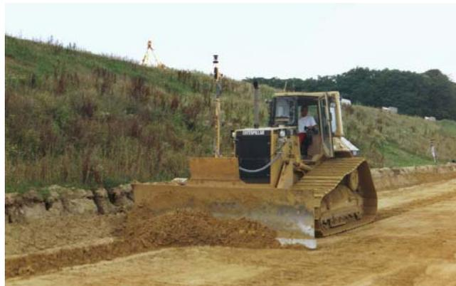
**Fig. N° 38. Sistema de seguimiento automático (AST) para Bulldozer. Control tridimensional.**
