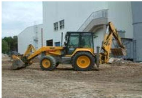
Fig. N° 16. Pala excavadora y cargadora combinada.
