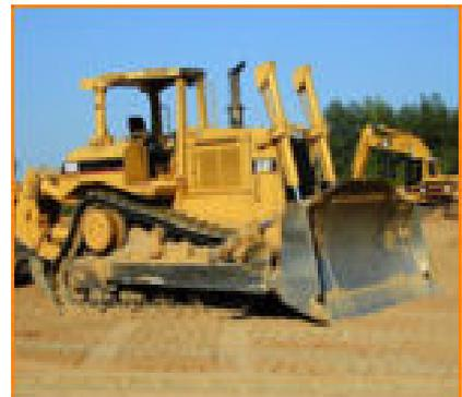
**Fig. N° 11. Tractor de oruga**
