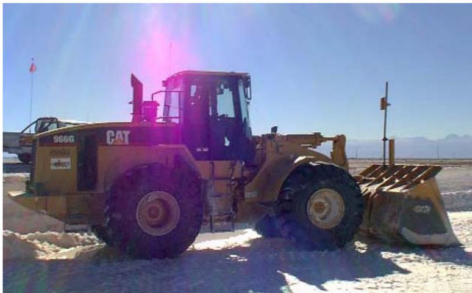
Fig. N° 31. Cargador Frontal con Sistema de Control Indicativo.
