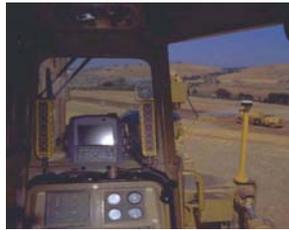
**Fig. N° 46. Bulldozer con sistema GPS, pantalla del operador.**
