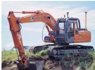
**Fig. N° 47. Excavadora con sistema GPS.**
