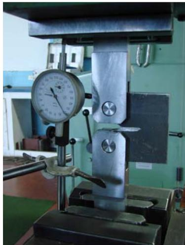
Figura 7.4. Ensayo de tracción
