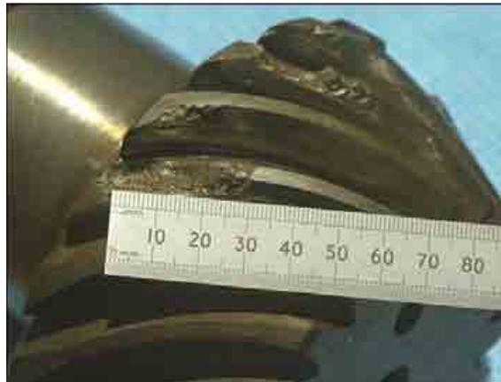
Figura 5.1. Superficie desintegrada [2].
