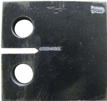
Figura 7.1. Probeta CT
