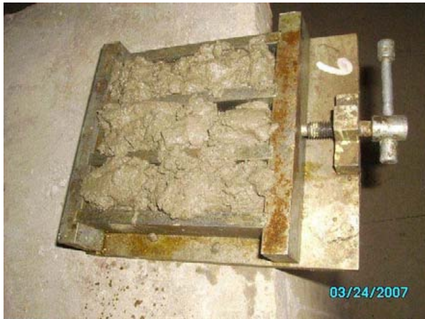
Figura N° 53 COLOCACIÓN SEGUNDA CAPA EN EL MOLDE RILEM PARA SER COMPACTADA
