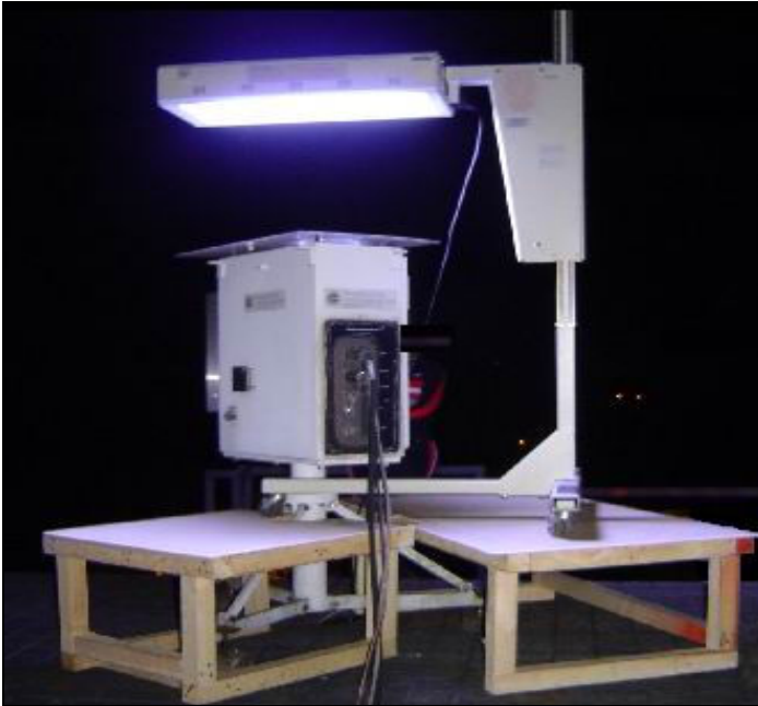
Figura 4.4 Unidad de fototerapia ubicada sobre el espectroradiómetro para mediciones de irradianza
