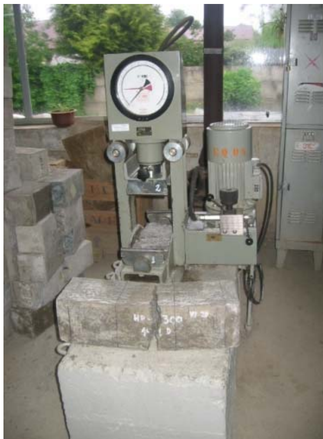
Fractura de la probeta en el tercio central de la luz de ensayo
