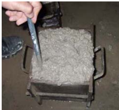
Fotografías N° 6: Vibrado de moldes cúbicos mediante varilla-pisón.
