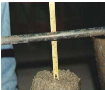
Fotografías N° 3: Procedimiento para el ensayo de asentamiento del cono de Abrams.
