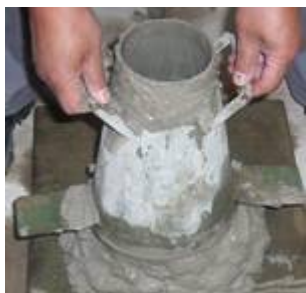
Fotografías N° 3: Procedimiento para el ensayo de asentamiento del cono de Abrams.
