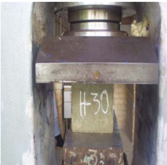
Fotografías N° 8: Ensayo de compresión a una probeta cúbica correspondiente a la mezcla patrón (antes del ensayo).
