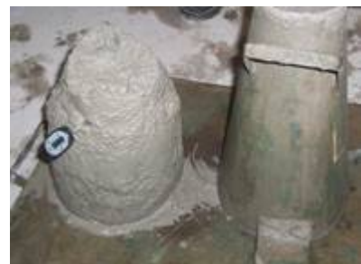
Fotografías N° 3: Procedimiento para el ensayo de asentamiento del cono de Abrams.
