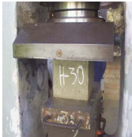
Fotografías N° 9: Ensayo de compresión a una probeta cúbica correspondiente a la mezcla patrón (después del ensayo).
