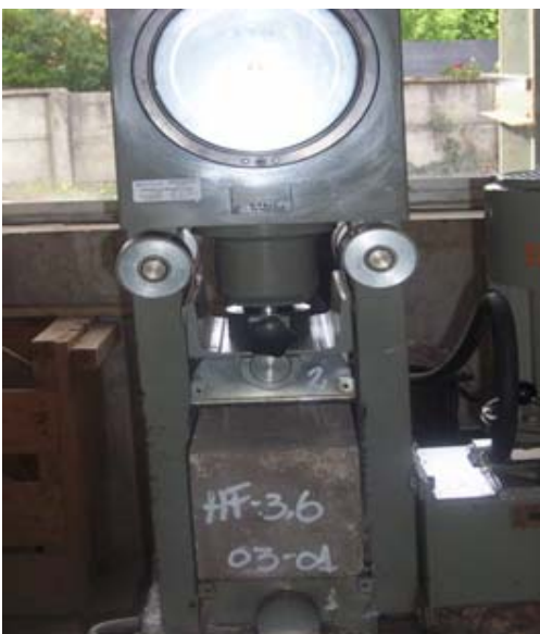
Fotografía N° 10: Ensayo de flexotracción a una probeta cilíndrica correspondiente a la mezcla con la tercera dosis de aditivo incorporador de aire y un 10% menos de agua (antes del ensayo).
