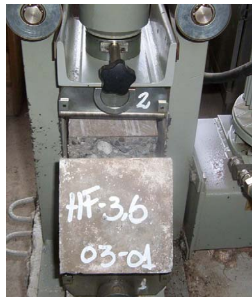
Fotografía N° 11: Ensayo de flexotracción a una probeta cilíndrica correspondiente a la mezcla con la tercera dosis de aditivo incorporador de aire y un 10% menos de agua (después del ensayo).
