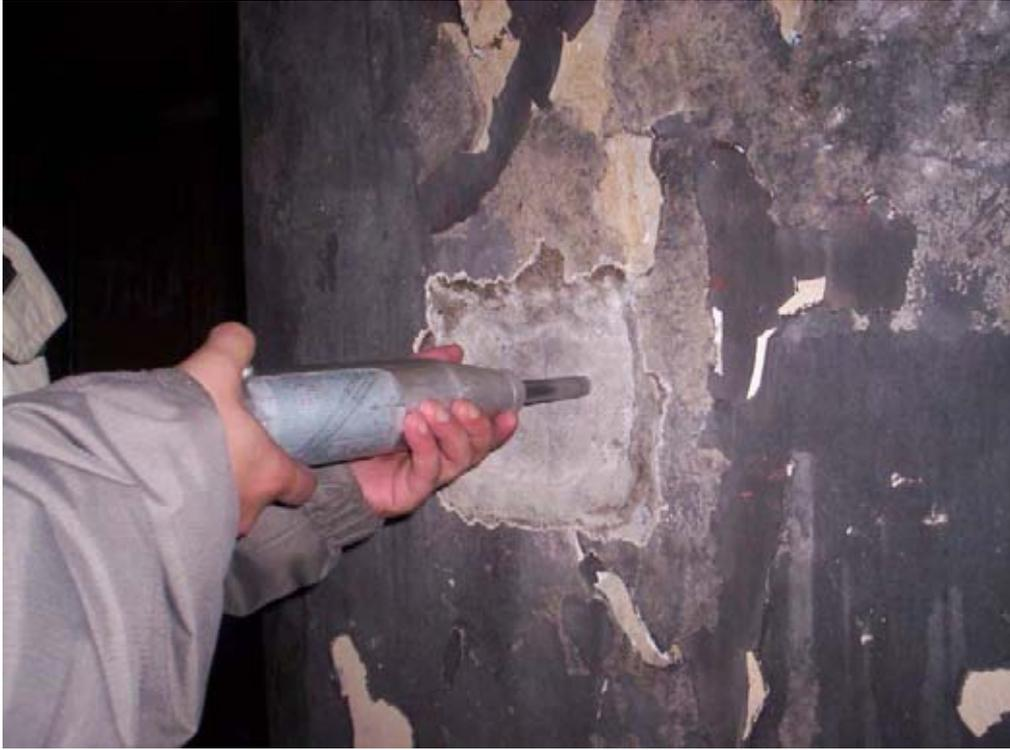
ENSAYO ESCLEROMETRICO APLICADO A UN PILAR.
