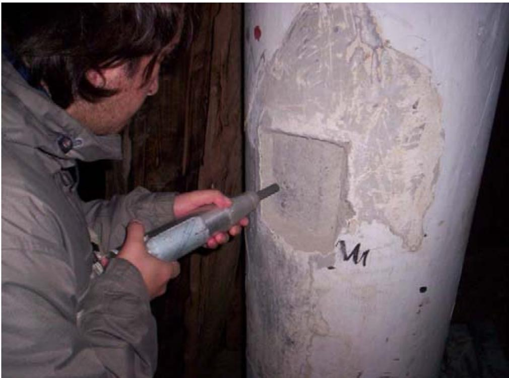
ENSAYO ESCLOEROMETRICO APLICADO A PILARES.
