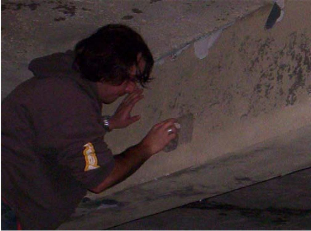
PREPARACION DE SUPERFICIE PARA ENSAYO ESCLEROMETRICO.
