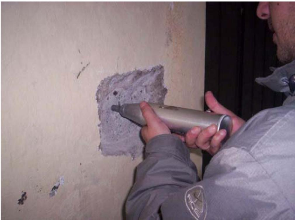
ENSAYO ESCLEROMETRICO APLICADO A UN MURO.
