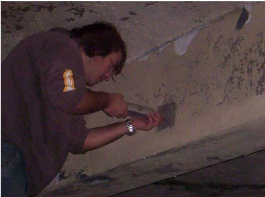
ENSAYO ESCLEROMETRICO APLICADO A UNA VIGA.
