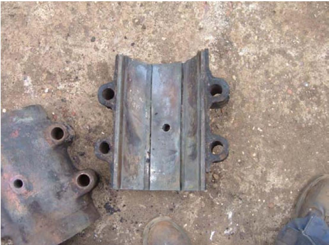
La fig.4 muestra la tapa de un descanso, antes de ser arenado.
