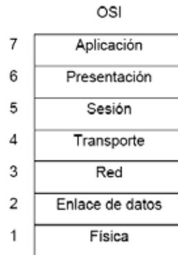
**Figura 2.** Capas del modelo OSI
