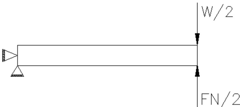
**FIG.3.19. Diagrama de cuerpo libre del Travesañ de Apoyo 1.**
