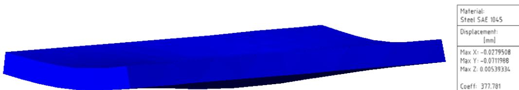
**FIG.3.12. Deformación sufrida por la Placa Corrediza, cuando esta realizando su máximo esfuerzo.**
