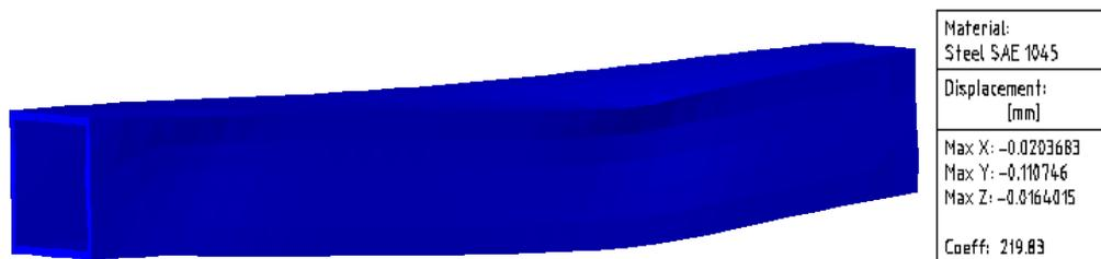
**FIG.3.15. Deformación sufrida por el travesaño 2', cuando está realizando su máximo esfuerzo.**
