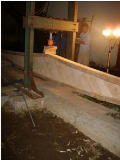
Viga flexionada en la plataforma de ensaye,
