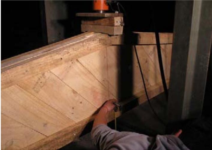
Peso Propio de Viga más cargas extras antes de ensayo, generan una deformación parcial, medida con huincha al milímetro
