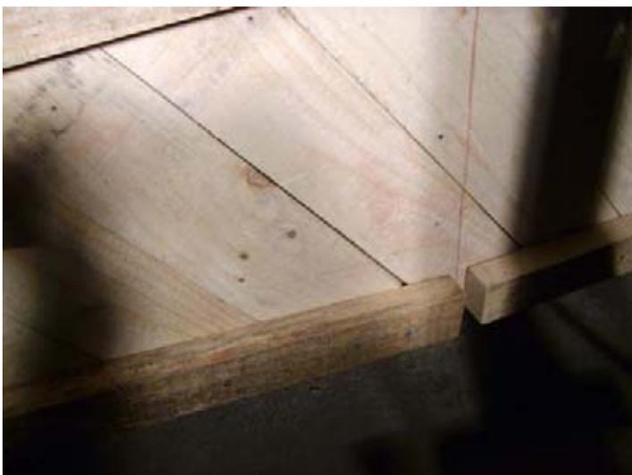
La viga al estar cargada centralmente por una carga puntual, esta produce en la parte superior una flexo Compresión y en la parte inferior una flexo tracción, que se ve reflejada con la separación de las piezas del alma en su parte inferior, a su vez en los extremos de la viga el alma se comprime.
