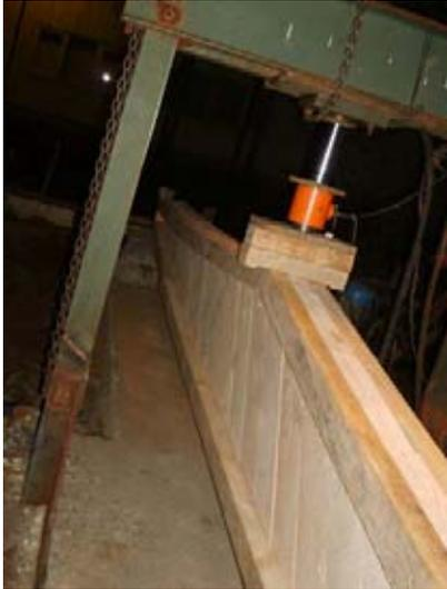
Viga Cargada con pistón Hidráulico en luz central
