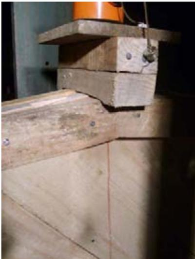
Viga cargada con pistón, cilindro metálico de recepción antes de celda de carga(no figura en la imagen), placa metálica entre celda y madera que reparte fuerza sobre toda la zona de contacto en la luz central, piezas de madera que logran la altura a la celda y además sirven para repartir la carga en la punta de la viga
