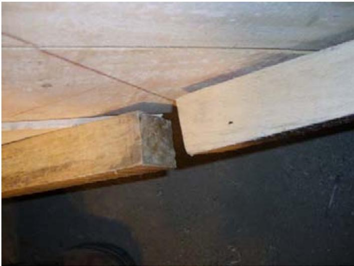
En la luz central de la viga, se experimento la mayor separación de las alas, producto al estar cargadas flexo Traccionadas, produciendo desprendimiento de la unión y permitiendo el descenso de la Viga en su deformación.
