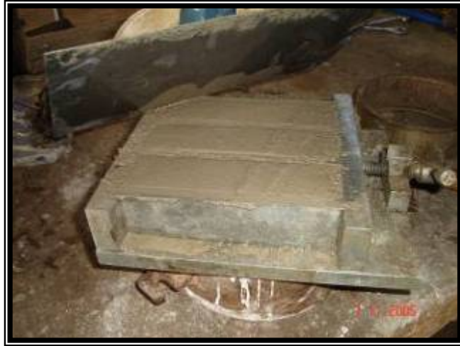
Enrasado de probetas Rilem Fuente: Elaboración propia
