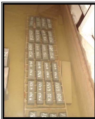
Probetas sumergidas en agua Fuente: Elaboración propia
