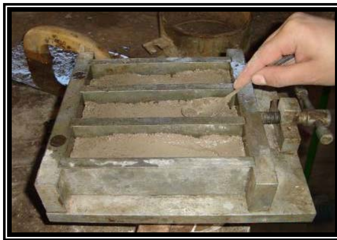
Llenado de probetas Rilem Fuente: Elaboración propia
