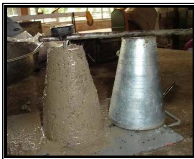
Medición asentamiento del cono Fuente: Elaboración propia
