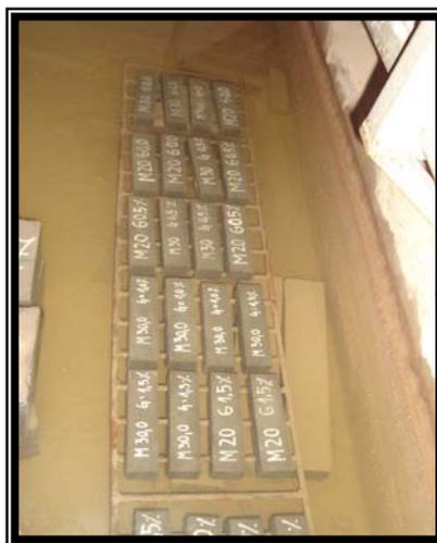
**Probetas sumergidas en agua**
