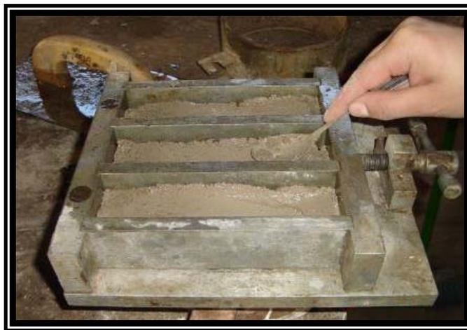
**Llenado de probetas Rilem**
