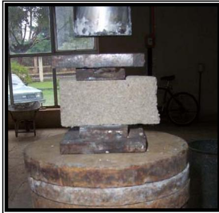
**Ensayo de compresión**
