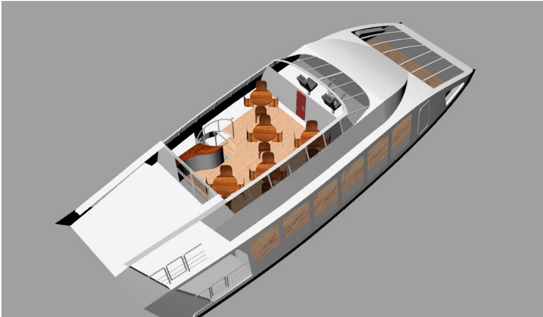
Figura 38: Disposición de la cubierta superior
