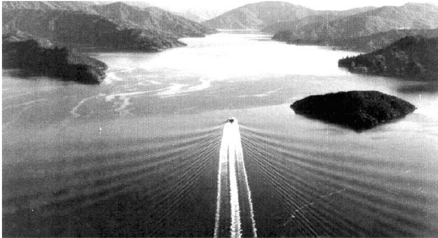
Figura 4: Tren de olas supercrítico
