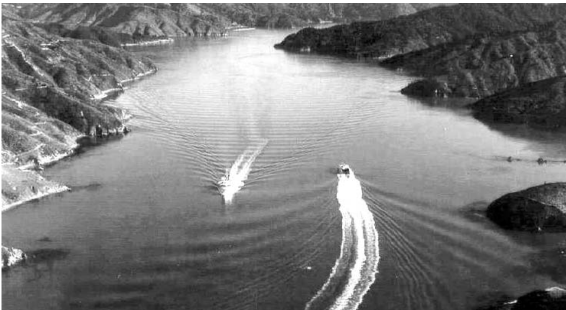
Figura 5: Embarcaciones navegando en régimen subcrítico y supercrítico
