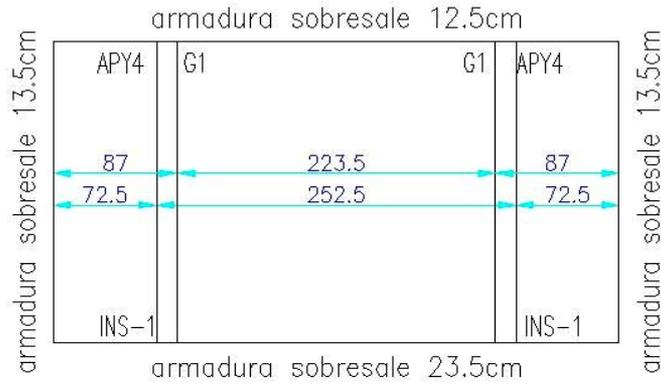
Esquema tipo de ubicación de insertos, apoyos y ganchos de izaje para un muro ciego.
