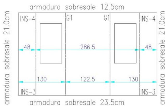
Esquema tipo de ubicación de insertos y ganchos de izaje para un muro de vanos de ventanas.
