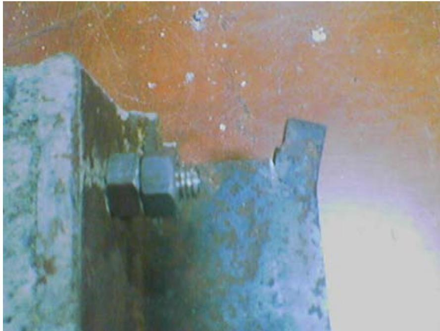
***Figura 6.3.3.3: Falla presentada en la pieza metálica soporte.***
