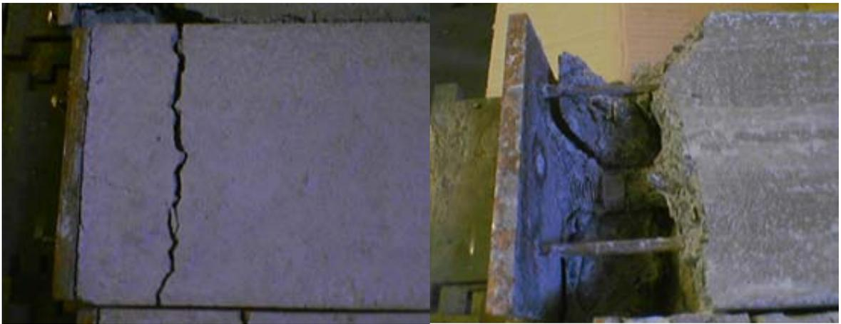
*Figura B.2b: Falla presentada por las probetas.*
