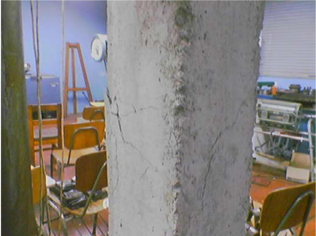
*Figura 5.3: Fallas presentadas en la viga traccionada.*
