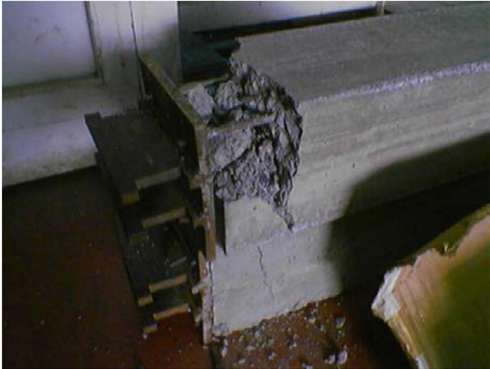
*Figura B.2a: Falla presentada por las probetas.*
