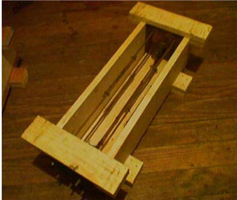
*Figura 4.3.2: Moldaje de probetas.*
