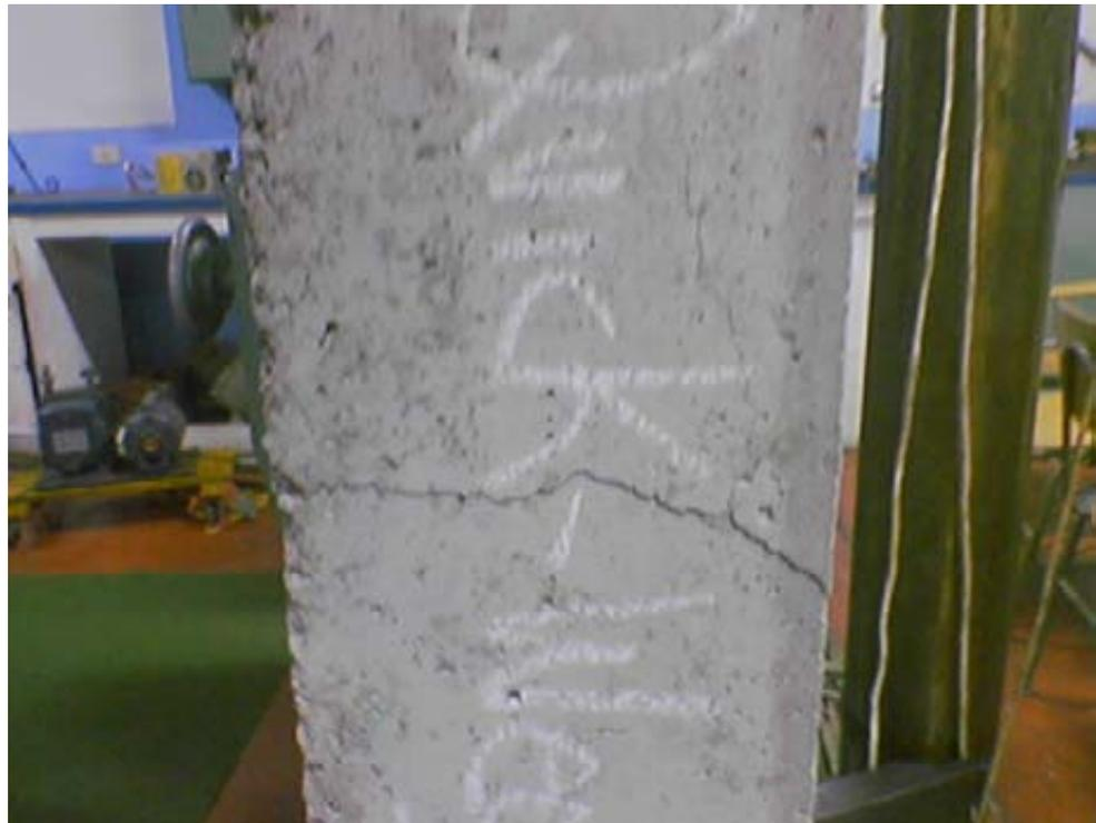
*Figura 6.3.3.1: Primera fisura que presenta la viga.*
