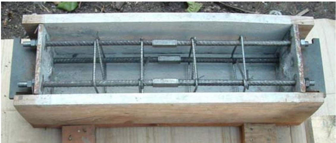
*Figura 4.4.3.1: Distribución armaduras en viga con Manguitos con Rosca cónica.*
