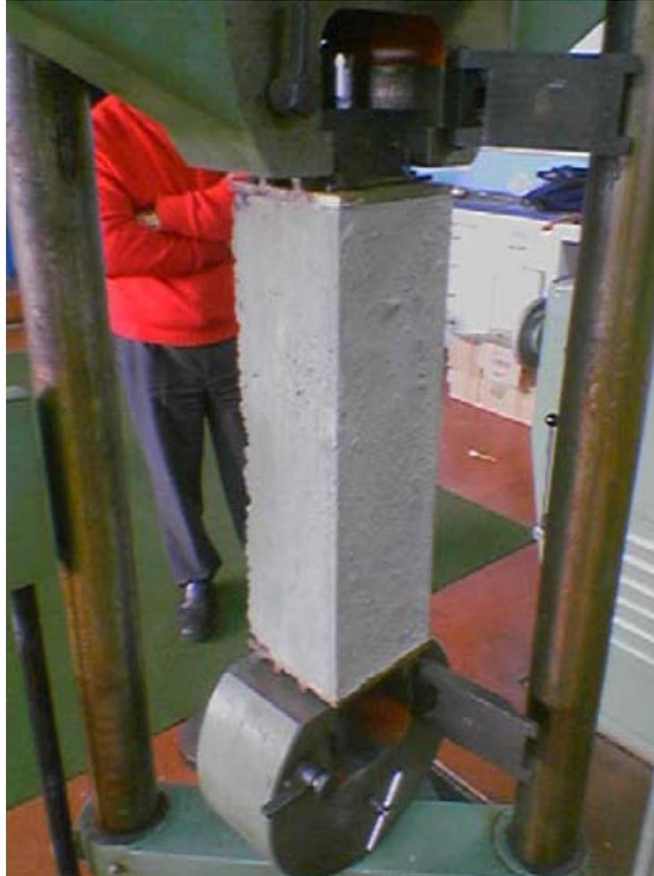
*Figura 5.2: Tenazas de la máquina tomando la probeta.*
