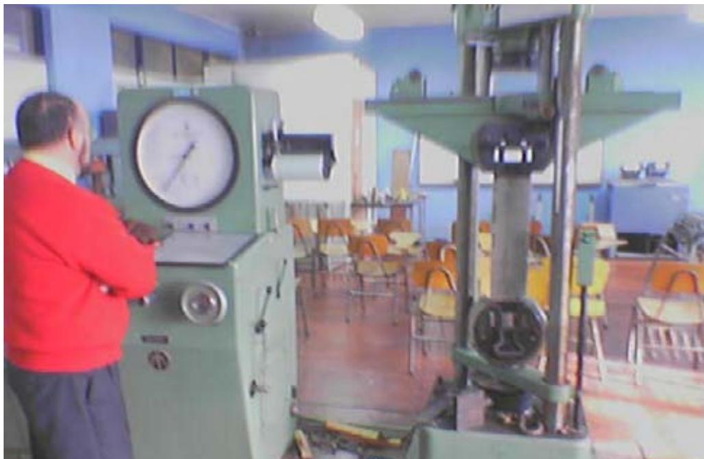
*Figura 5.1: Máquina Universal de Ensaye de Materiales.*
