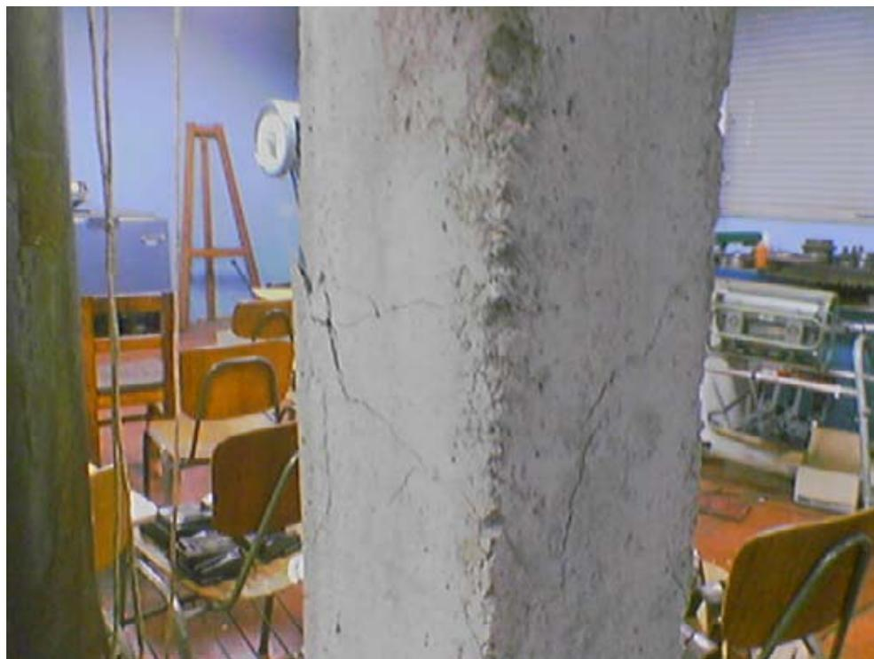
*Figura 6.3.3.2: Resto de fisuraciones presentadas por la viga.*
