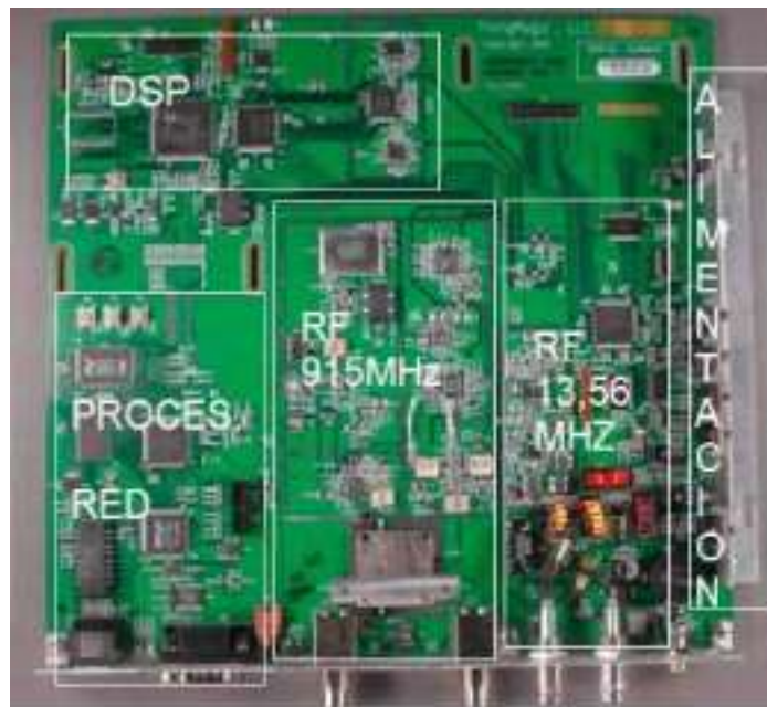
Figura 8. Diseño interno de un lector que puede trabajar con dos frecuencias. FUENTE: Ciudad J., 2005.
