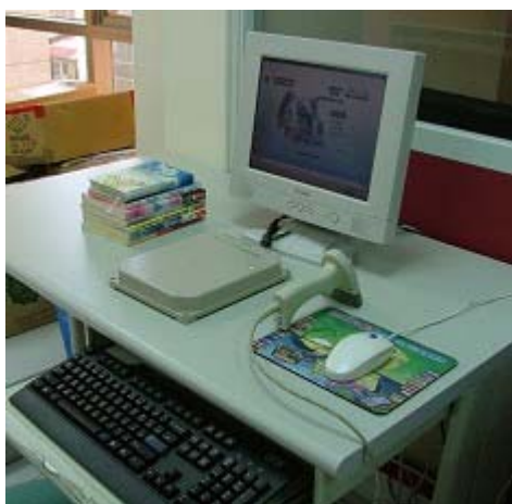
Figura 60: Estaciones de trabajo del personal con sus principales componentes, un computador, lector/grabador de RFID, teclado y lector de código de barras.
