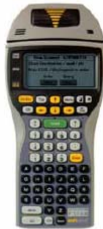
Figura 9: Lector de mano de corto alcance que trabaja a la frecuencia de 900MHz. FUENTE: Ciudad J., 2005.
