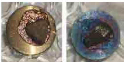
**Figura 3.24 y 3.25:** A la izquierda resultado preparación muestra con oro. A la derecha resultado preparación muestra con carbón. (Fuente: Elaboración propia).
