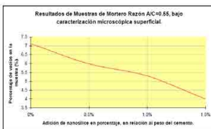
Figura B.2: Adición de nanosílice v/s Porcentaje de vacío de la muestra. (Fuente: Cárcamo, 2006).
