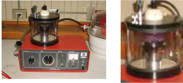
**Figura 3.21 y 3.22:** Máquina utilizada para el recubrimiento de las muestras con oro, llamada máquina sombreadora de oro. (Fuente: Elaboración propia).
