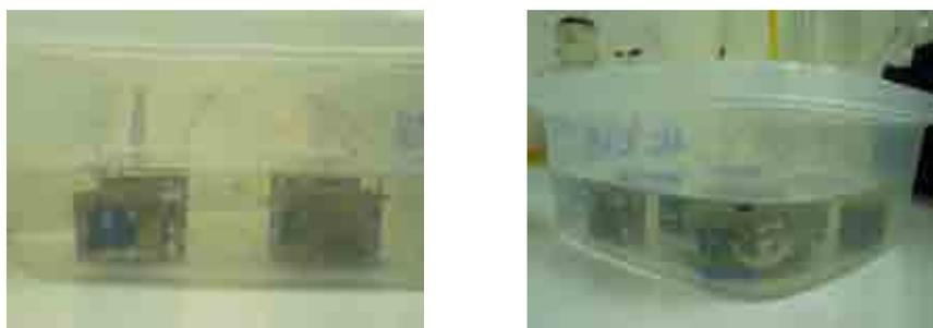
**Figura 3.2 y 3.3:** Discos introducidos en sus respectivos recipientes plásticos, sumergidos completamente, marcando el nivel de la solución en estos. (Fuente: Elaboración propia)
