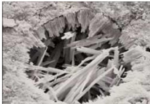
**Figura 2.10:** formación de cristales de etringita en el concreto. (Fuente: Cárcamo, 2006)
